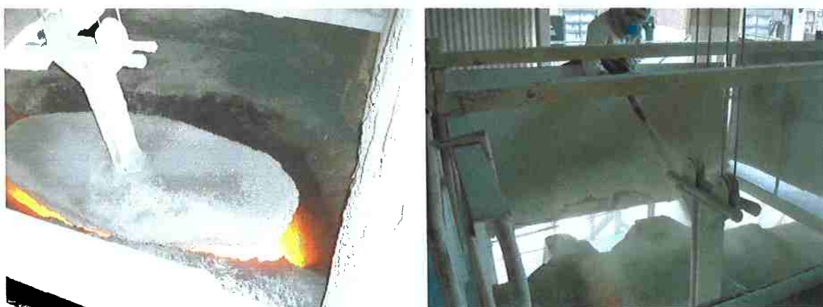
Figura 2.24. Recomposição do revestimento monolítico da região da boca através do método de gunning à quente.
