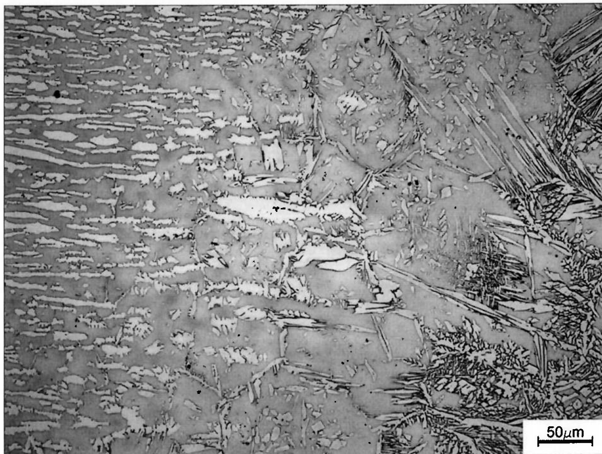
Figura 5.7- Microestrutura da ZAC. Ataque eletrolítico com NaOH (200x).
