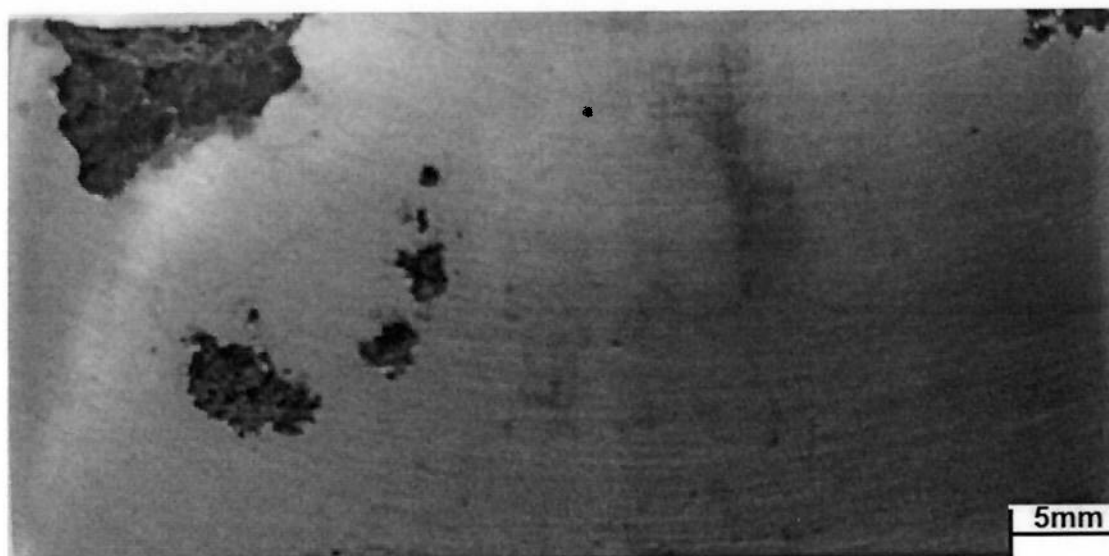
Figura 5.12- Aparência visual da amostra do metal de base após ensaio corrosão, conforme ASTM G48 método A, à 50°C por 72h.
