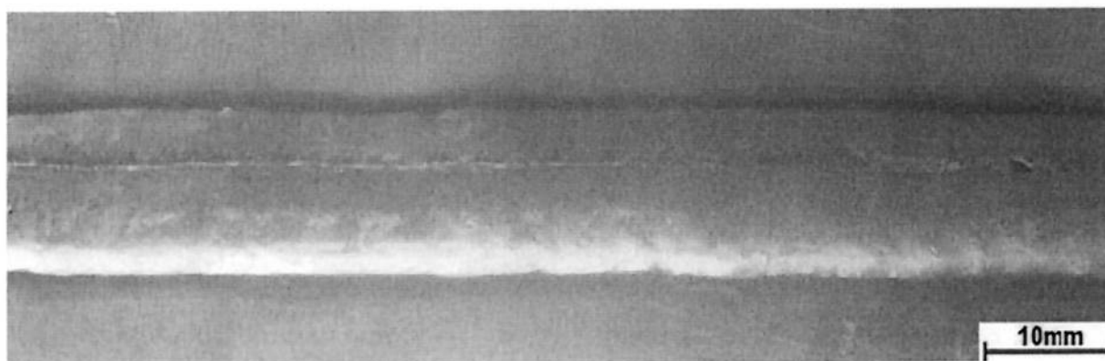
Figura 5.2- Aspecto visual da soldagem da junta soldada com 100% CO 2 .
