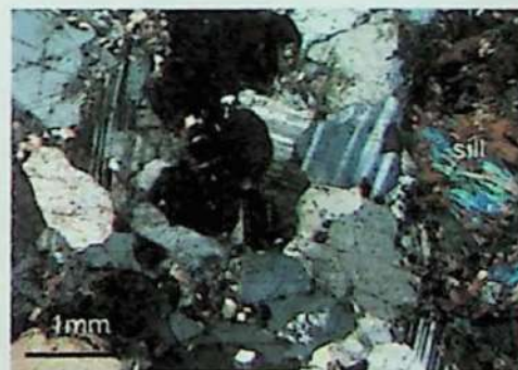
B(NicóisX) Sillimanita xenomórfica e parcialmente substituída por minerais micáceos, a direita na foto.
