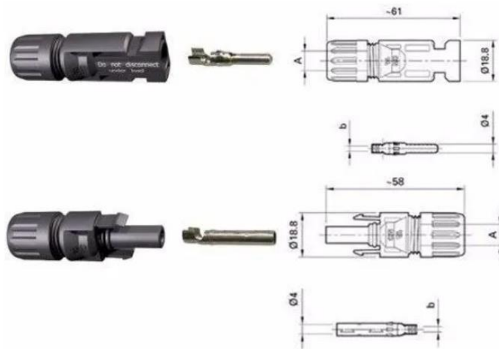
Figura - 4.17 – Conectores MC4 macho e fêmea
