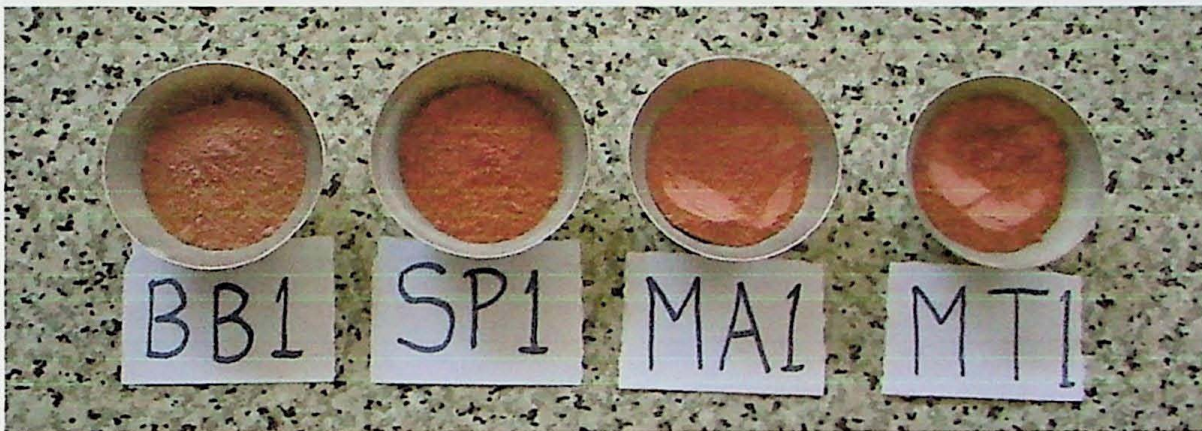
Foto 09 – Amostras umidificadas e pesadas (20g cada), prontas para prensagem.
