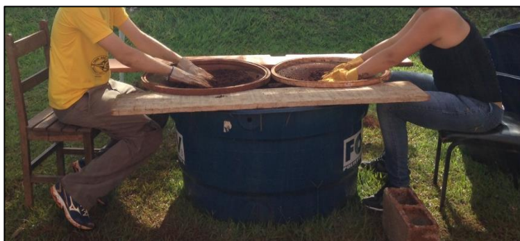
Figura 4.6: Realização do peneiramento do solo
