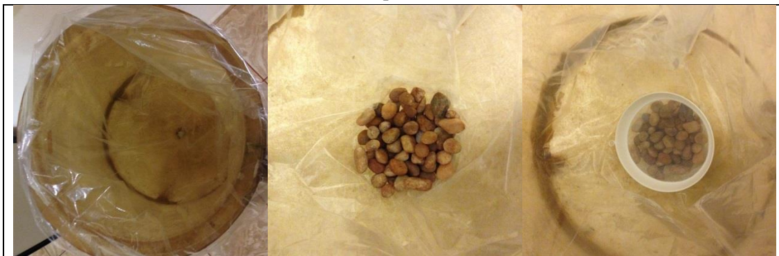
Figura 4.2: Procedimento de montagem dos simuladores, com detalhe para a parte interna dos mesmos, com a peneira e cascalho.
