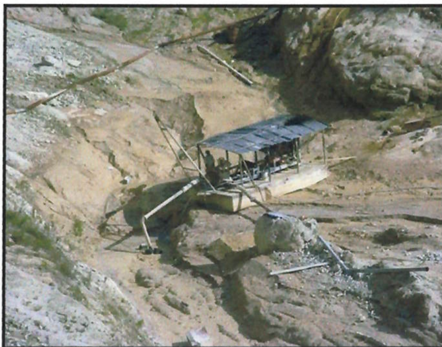
FIGURA 2.1.3.3. - Draga que transfere, por meio de bombas centrífugas, o material desmontado hidraulicamente para a fase de beneficiamento do processo.
