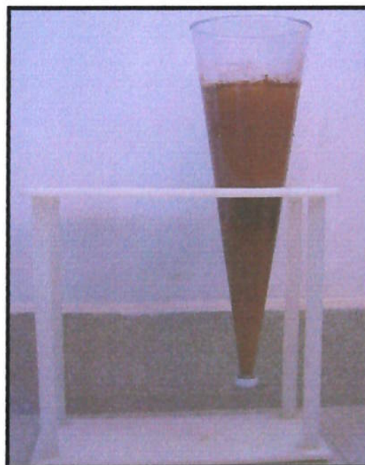
FIGURA 3.5.6. – Teste de sedimentação realizado com o Cone Imhoff.
