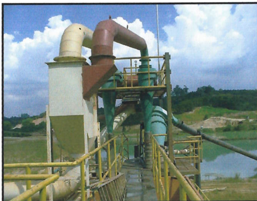
FIGURA 2.2.3.2. - Vista dos hidrociclones existentes no processo de classificação de materiais do empreendimento.
