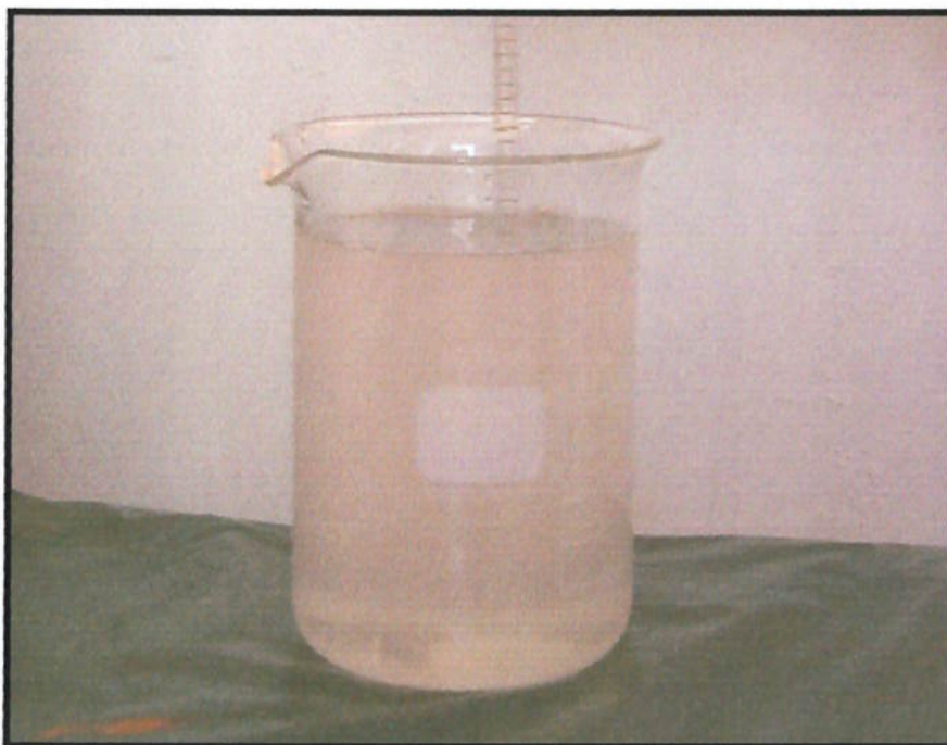
FIGURA 3.5.3. - Preparação da solução de cloreto de cálcio na concentração definida, para os ensaios do tipo Jar-Test.
