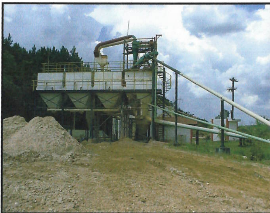
FIGURA 2.2.3.3. – Observa-se os silos de estocagem e expedição onde são armazenadas as areias grossas, médias e finas.
