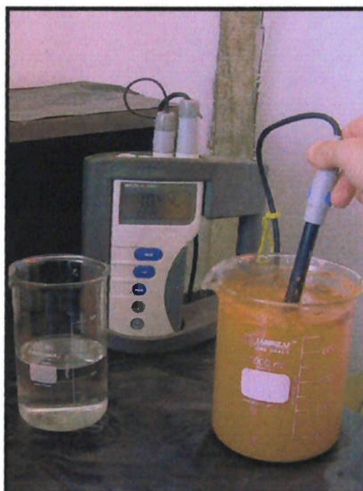
FIGURA 3.5.4. - Medição de pH da amostra inicial, ainda sem a presença de produtos químicos.
