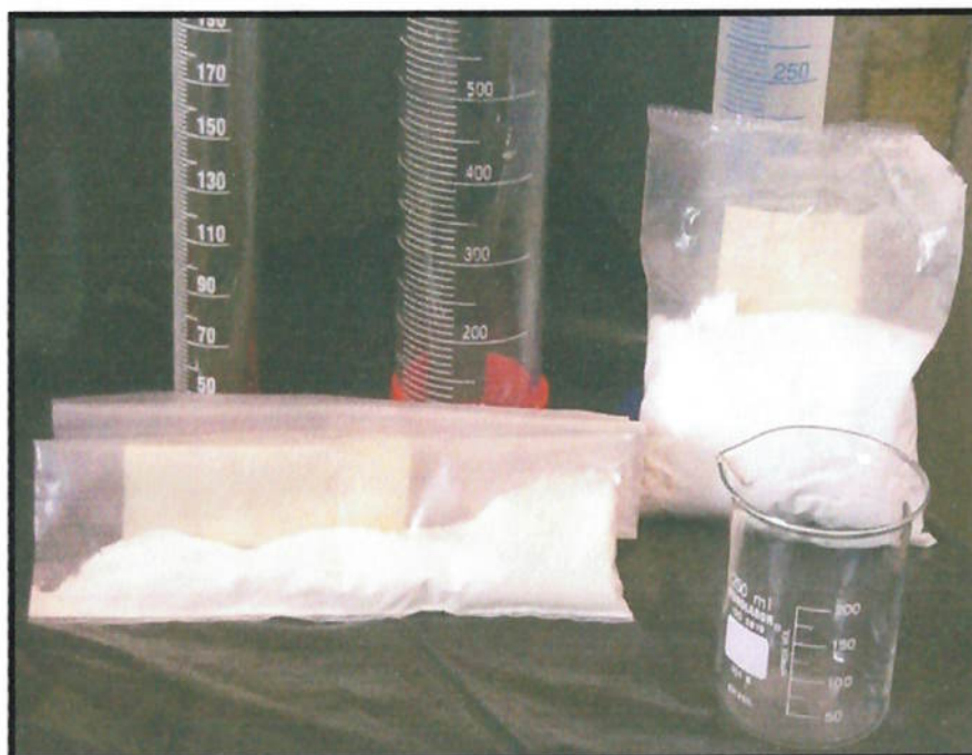
FIGURA 3.5.2. – Produtos químicos (cloreto de cálcio e sulfato de alumínio) utilizados nos ensaios de dosagem química.
