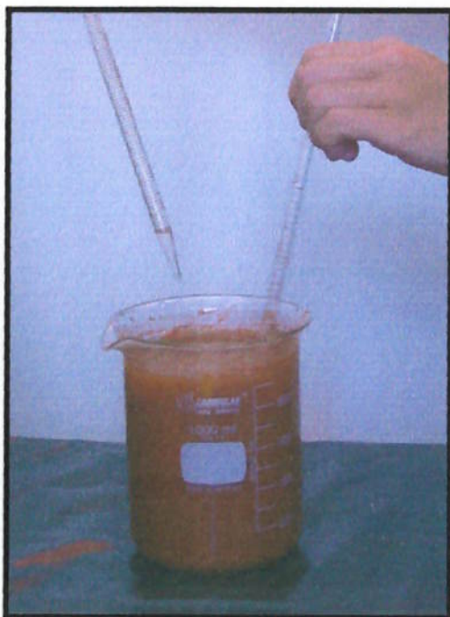
FIGURA 3.5.5. – Realização de dosagem de produto químico à amostra, mantendo-se uma agitação de velocidade constante.
