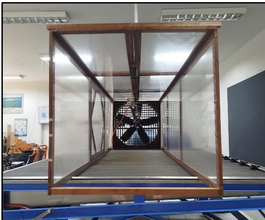
Figura 3.1.2. Saída do túnel de vento.
