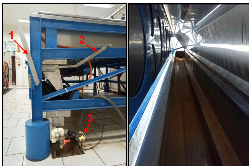
Figura 3.1.5. Vista lateral da mesa com suas alavancas (1 - Para o controle das provetas; 2 - Para o direcionamento do fluxo de água) e a bomba de retorno (3) à esquerda e seu reservatório secundário à direita.
