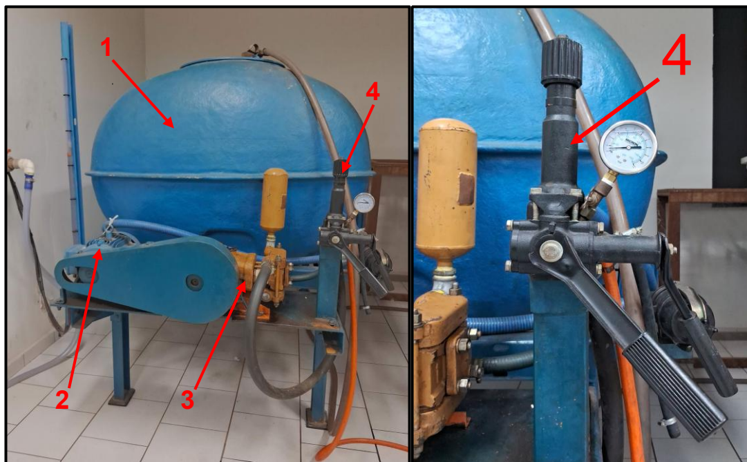
Figura 3.1.6. Conjunto tanque principal (1), motor elétrico (2), bomba de êmbolo (3) e comando hidráulico (4), à esquerda, e detalhe do comando hidráulico à direita.
