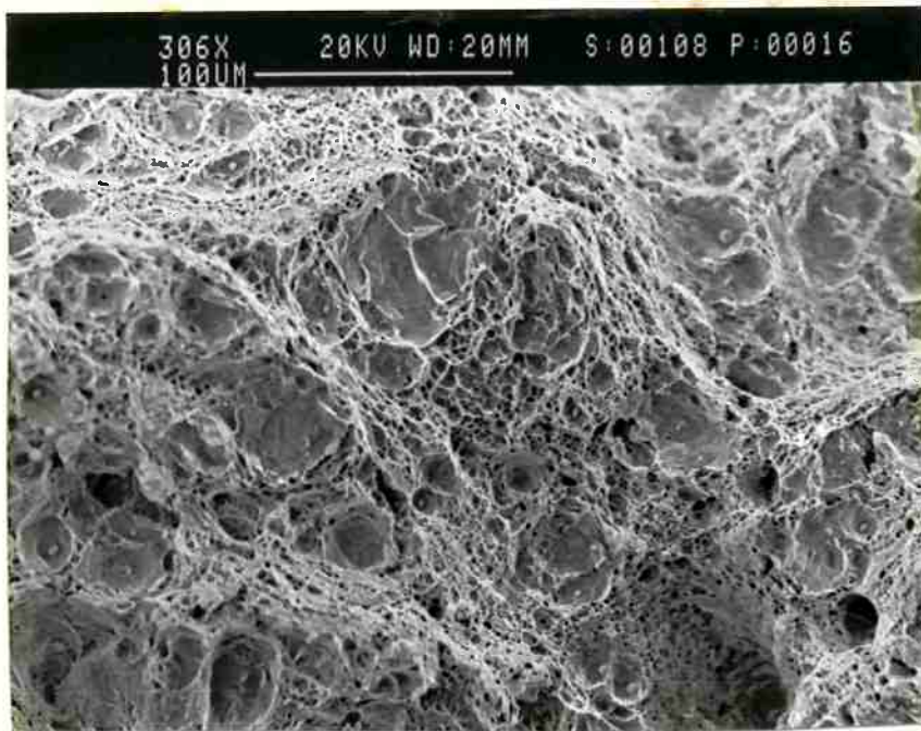
FIGURA 33 - amostra Q11 - Fratura por dimples.(160°C). (300x)
