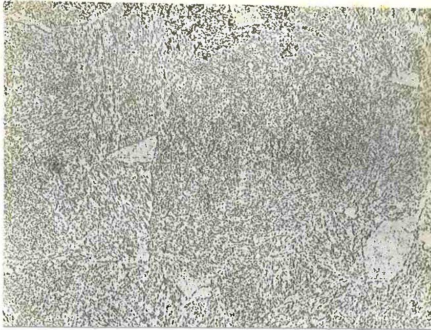
FIGURA 24 - Aspecto microestrutural das amostras do lado frio. (500x) Ataque: Nital.
