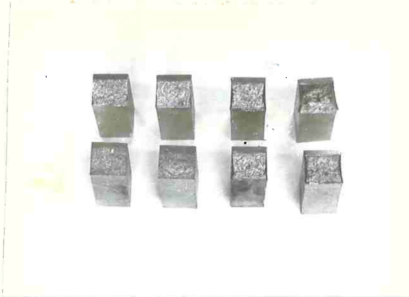
FIGURA 42 - Exame visual das superfícies de fratura. (amostras QR em cima, amostras Q em baixo)
