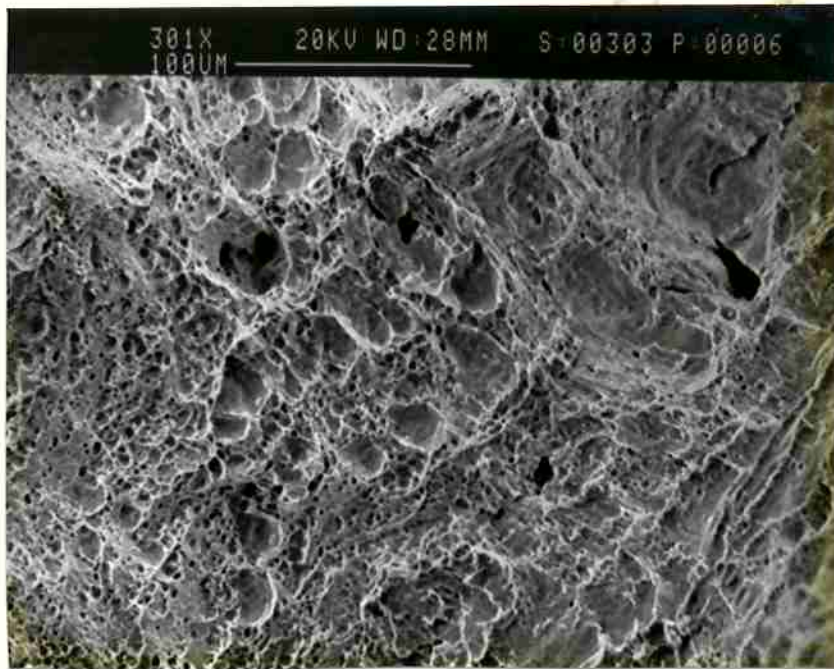
FIGURA 46 - amostra QR9 - Fratura por dimples.(90°C) (300x)
