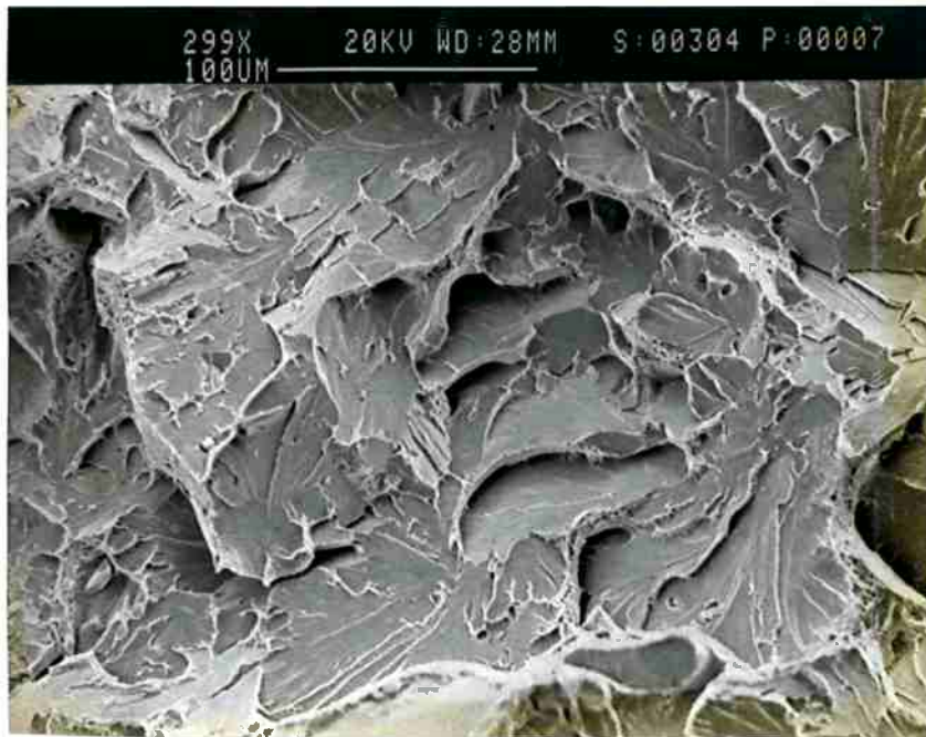
FIGURA 51 - amostra S5 - Fratura mista com clivagem e trincas secundárias (20°C). (300x)
