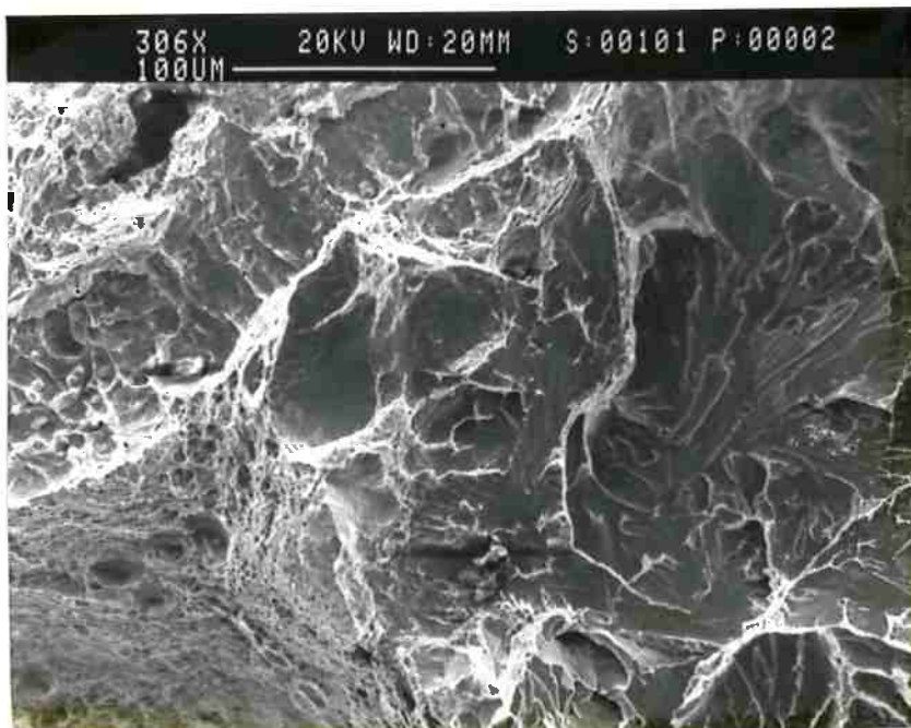
FIGURA 30 - amostra - F5 Fratura mista com clivagem e dimples.(20°C). (300x)
