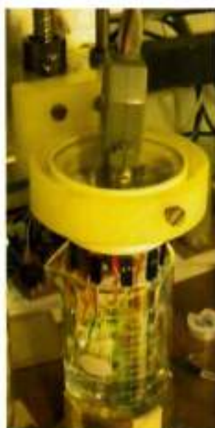
Figura 22: Língua eletrônica sendo medida através do equipamento atual
