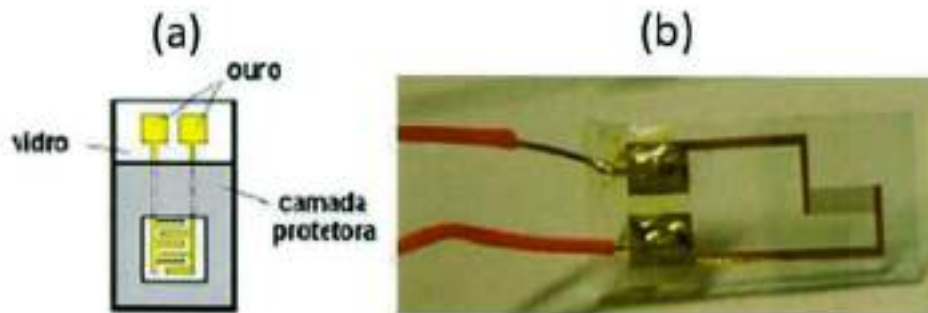
Figura 1: Sensor da língua eletrônica: (a) Estrutura do sensor destacando as camadas que o compõem. (b) fotografia dos microeletrodos interdigitados e dos terminais. Adaptado da referência [2]
