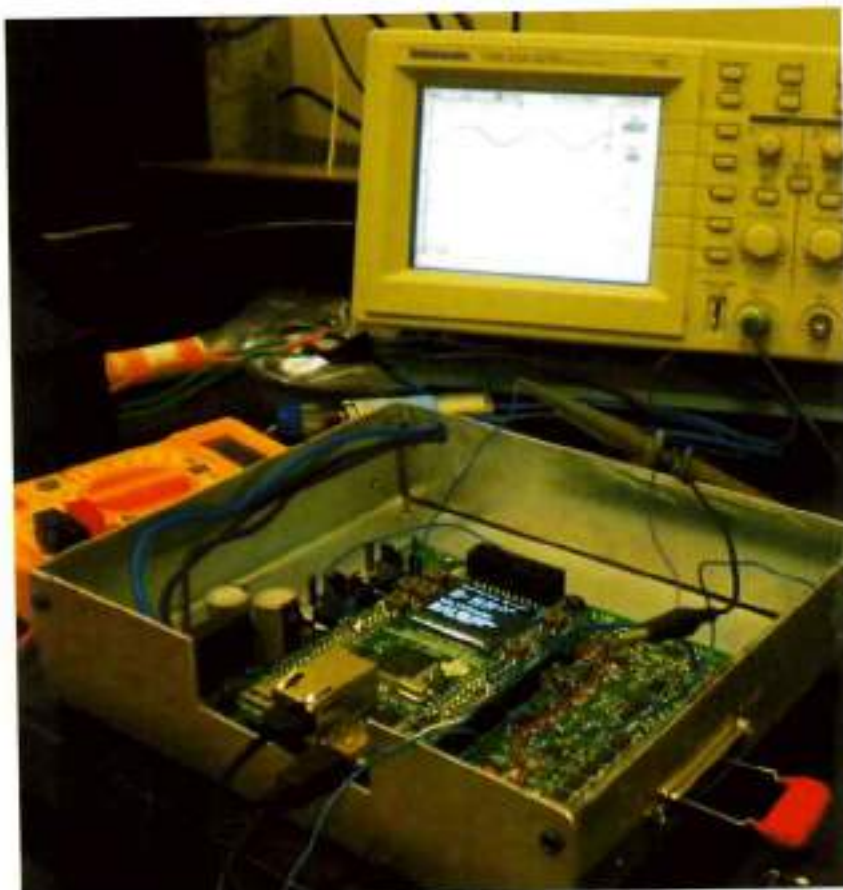
Figura 20: Circuitos amplificadores diferenciais em funcionamento
