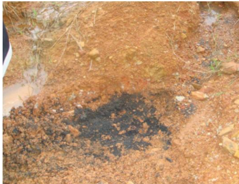
Figura 6. Escória, com fina camada de solo, permanecendo visível e passível de lixiviação
