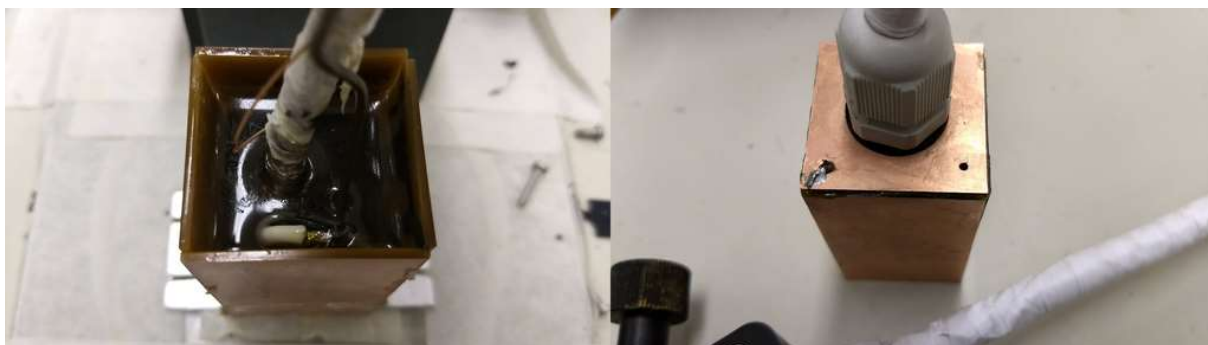
Figura 20 – Preenchimento da camada de backing e carcaça fechada com detalhe do furo para inserção da resina epóxi e terra soldado na carcaça
