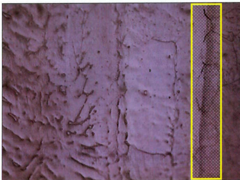
Figura 5.3: Imagem identifica região de carbono migrado junto a ZF
