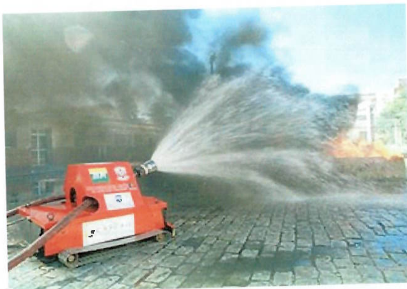
Figura 9. Robô de jatos de água de alta pressão em ação. Primeiro robô brasileiro para combater incêndios.
