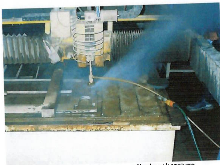
Figura 4. Ricochetear de partículas abrasivas Fonte: RADVANSKÁ, 2007
