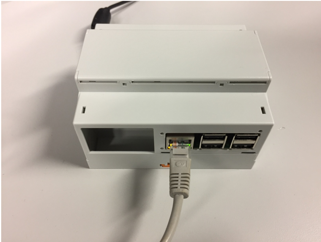
Figura 15 – Raspberry Pi utilizada no trabalho instalada em uma caixa para trilhos DIN
