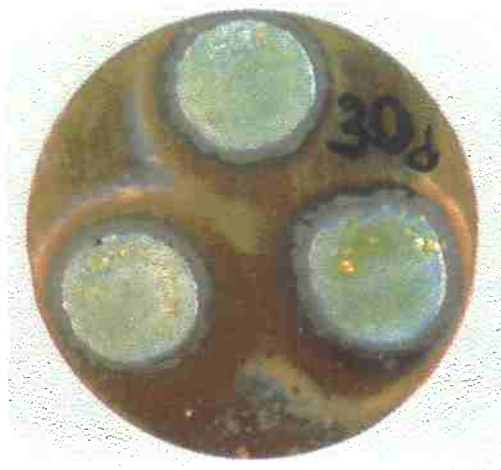
Figura 39: Formação de "solder balls" no ensaio.
