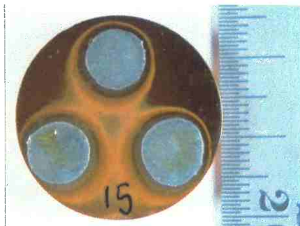
Figura 38: Junta fria obtida no ensaio.
