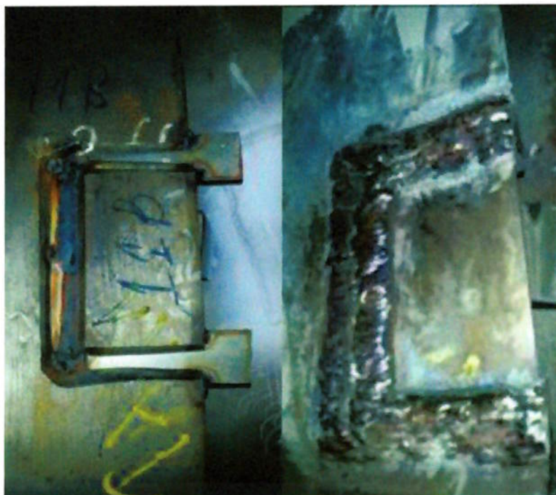
Figura 4.13 – Soldagem por processo FCAW
