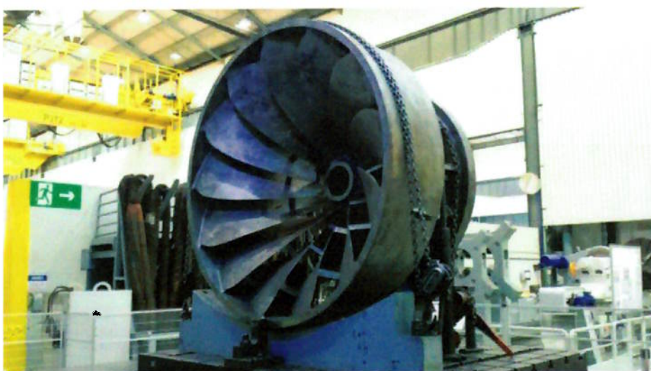
Figura 4.3 – Rotor travado na máquina para usinagem dos insertos
