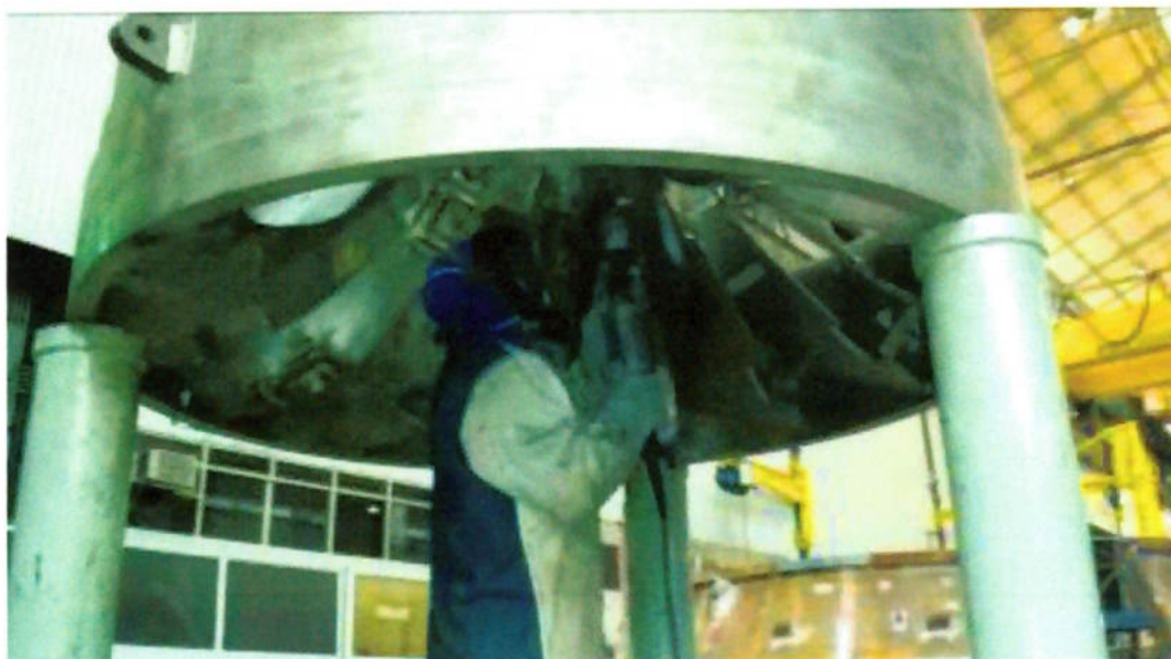
Figura 4.17 – Lixamento para ajuste mecânico
