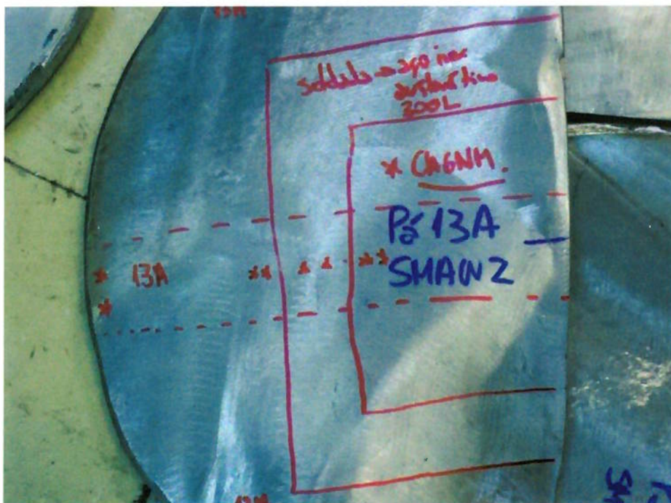
Figura 4.20 – Corte do CP para medição no difratômetro
