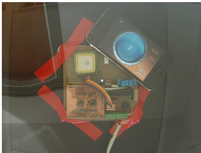
Figura 22 - Módulo sensor fixado no painel do carro, nivelado a partir do aplicativo Carpenter para iPhone.
