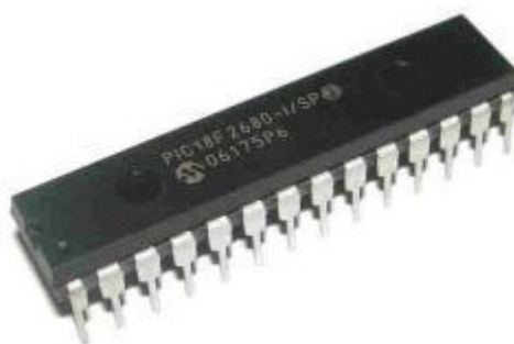
Figura 9 - Microcontrolador Microchip PIC18F2680, encapsulado no formato PDIP com 28 pinos.
