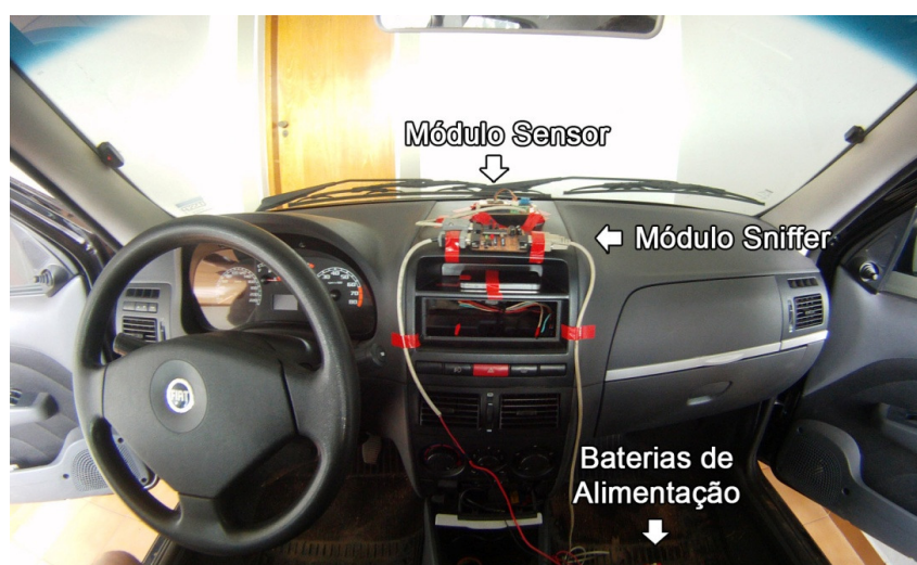
Figura 23 - Montagem do sistema em um veículo de passeio, com o propósito de testar seu funcionamento.
