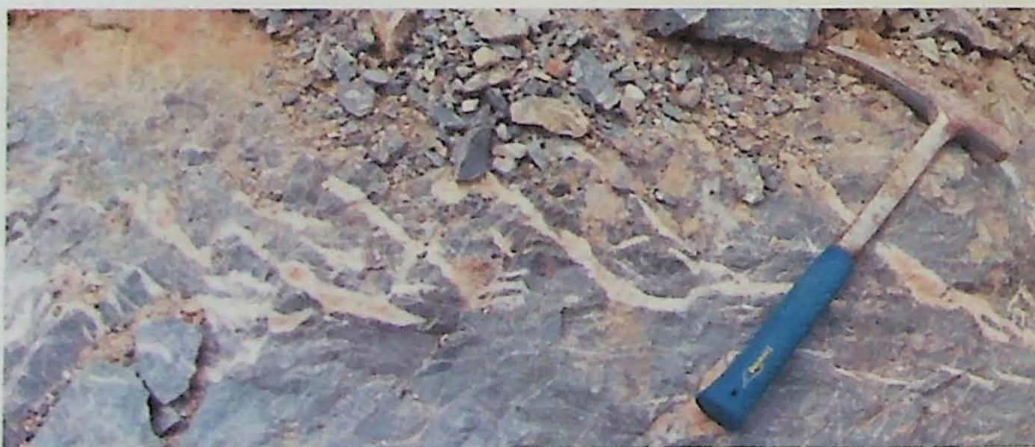
Figura 22: Veios sigmoides de calcita na brecha dolomítica no ponto BG-23 indicando movimentação dextral (NE-SW).
