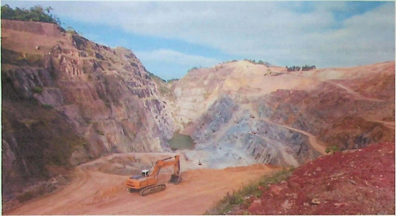
Figura 17: Vista geral da mina Vau Novo (Corte S-N) – Foliação bem marcada no lado esquerdo, com mergulho para norte.
