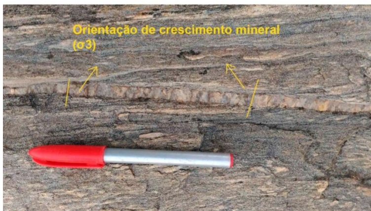
Figura 7: Estereograma com os planos dos veios extensionais e seus respectivos polos plotados. Abaixo, uma foto do veio extensional, retratando a orientação de crescimento mineral dos grãos de quartzo, a qual é, aproximadamente, perpendicular ao plano da fratura. Sendo assim, infere-se que a direção do \sigma_3 possui orientação NNW/SSE/sub-horizontal.
