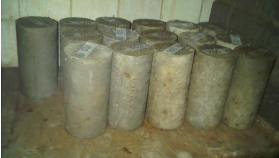
FIGURA 8: CORPOS DE PROVA EM CÂMARA ÚMIDA
