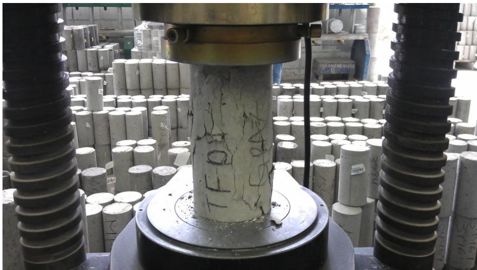
FIGURA 9: ENSAIO DE COMPRESSÃO DE CORPO DE PROVA CILINDRICO.
