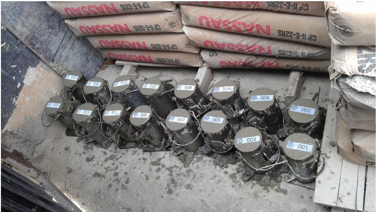
FIGURA 6: CORPOS DE PROVA MOLDADOS E ENUMERADOS
