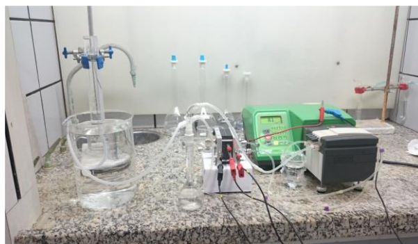
Figura 12. Esquema experimental para análise de volume de hidrogênio; imagem adaptada (1)
