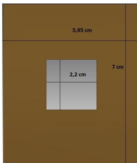
Figura 7. Medidas do espaçador de malha de fibra de vidro desenhada utilizando software Solid Edge ST7
