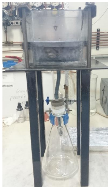
Figura 6. a) Componentes utilizados para filtração; b) Arranjo montado para realização do processo de filtração
