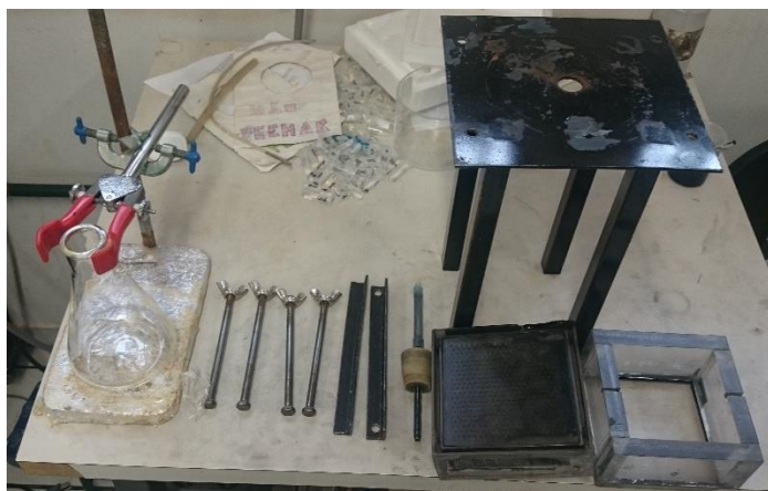
Figura 6. a) Componentes utilizados para filtração; b) Arranjo montado para realização do processo de filtração
