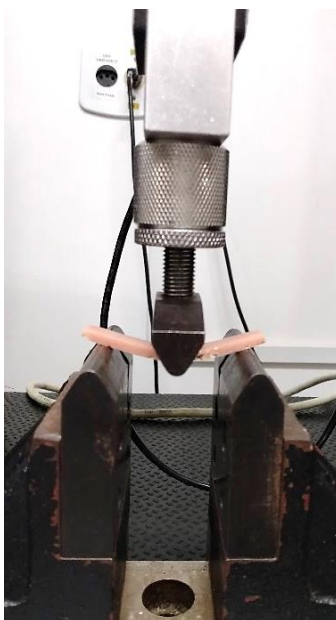
Figura 27. Ensaio de resistência à flexão em Máquina de Ensaio mecânicos.
