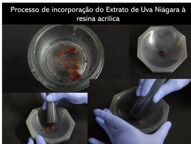
Figuras 20. Processo de manipulação da resina acrílica com os extratos naturais experimentais
