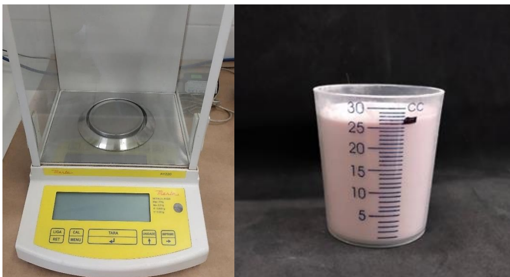
Figura 18. Balança utilizada para pesagem e medida demarcada do polímero, respectivamente.
