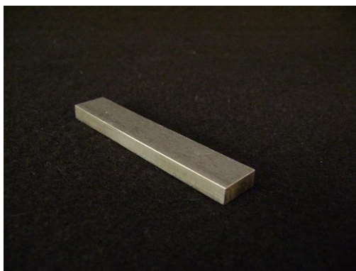
Figura 17. Matriz retangular metálica para obtenção dos corpos de prova em resina acrílica.
