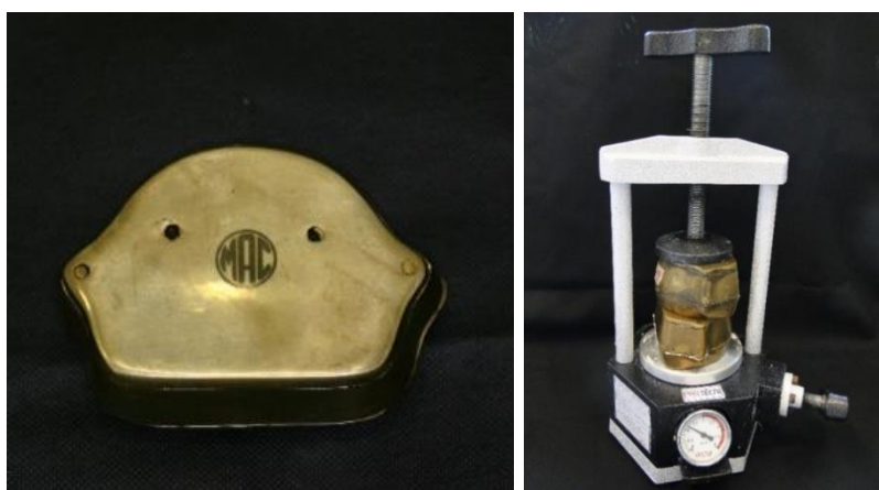
Figuras 21. Mufla empregada e muflas com resina acrílica sendo prensada
