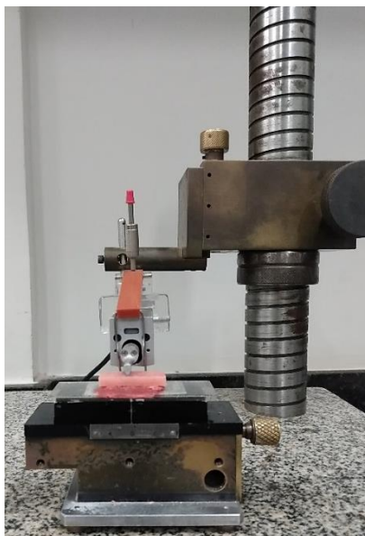
Figura 28. Ensaio de rugosidade de superfície através de Rugosímetro
