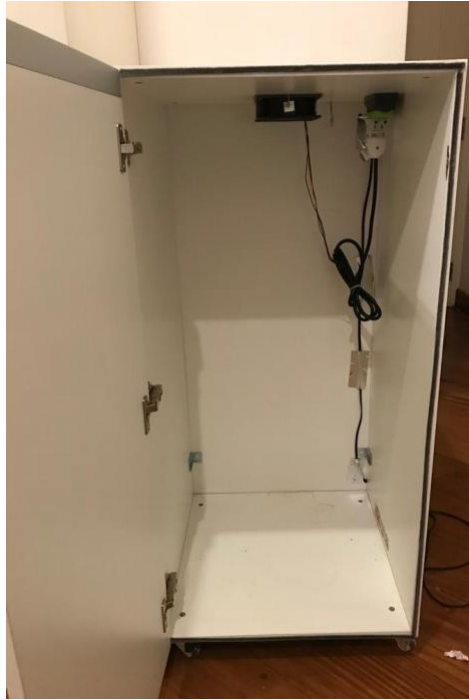
Figura 10 - Fluxo de ar direcionado para fora da estufa.
