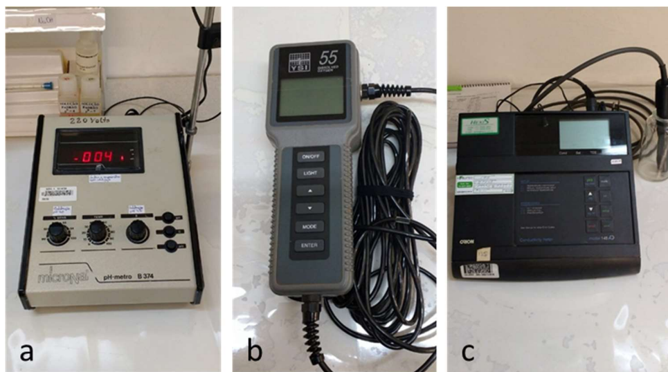
Figura 5. Aparelhos utilizados para a medição dos parâmetros físico-químicos das amostras. (a) pH-metro Micronal B74 (b) oxímetro YSI 55; (c) condutivímetro Orion 145A+.
