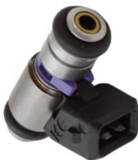
Figura 32 - Injetor de combustível utilizado nesse projeto.
