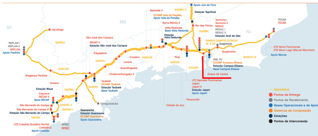
Figura 3.6 – Malha de transporte de gás natural da região sudeste operada pela empresa NTS (Nova Transportadora do Sudeste S.A), com destaque para a região de Duque de Caxias no Rio de Janeiro
