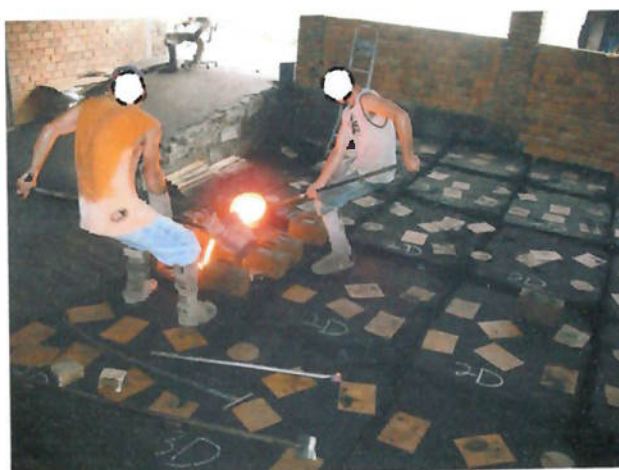
Figura 7 - Alimentador de linha de produção 2, vazando metal fundido no molde.
