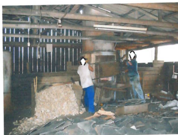
Figura 4 - Alimentador de linha de produção 1 alimentando forno cubilô.
