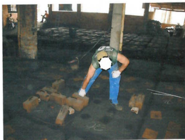
Figura 10 - Acabador de moldes, colocando os pesos sobre o molde seguinte.
