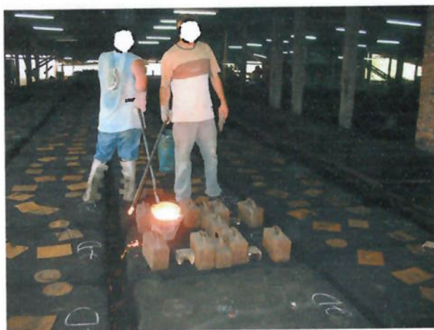
Figura 9 - Acabador de moldes, retirando as impurezas do metal fundido.
