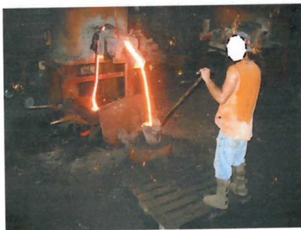
Figura 5 - Alimentador de linha de produção 2, enchendo o caneco com metal fundido.
