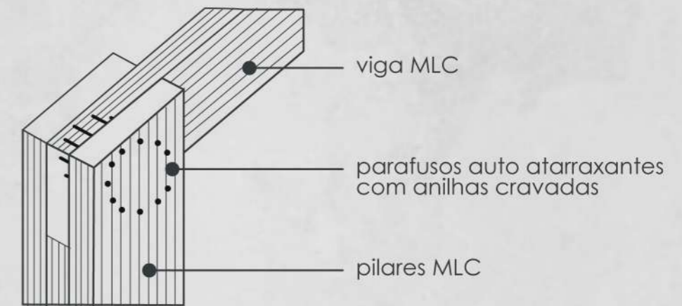
FIXAÇÃO VIGA X PILAR
