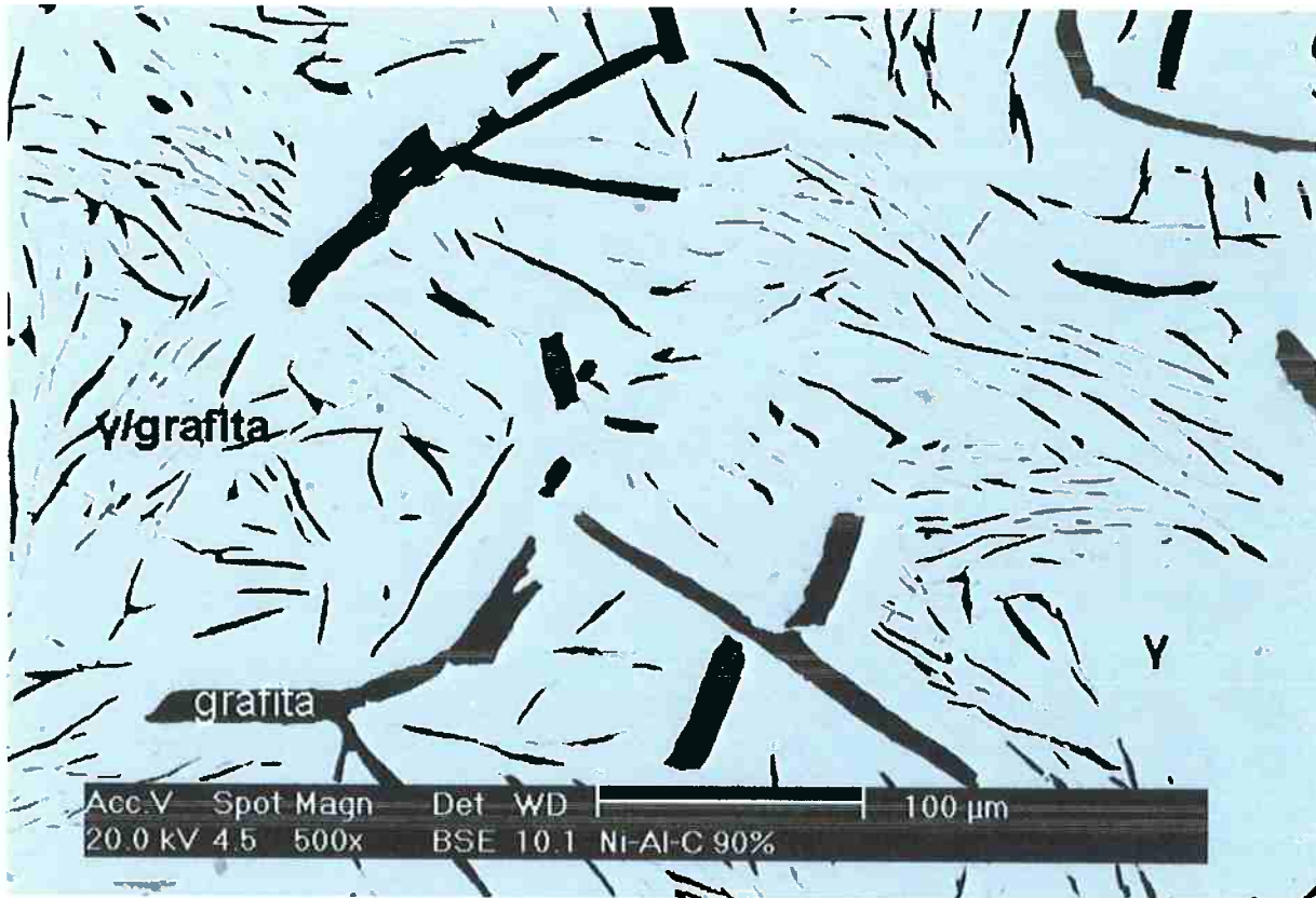
Figura 23: Amostra 06 bruta de solidificação. Imagem de microscópio eletrônico de varredura com elétrons retroespalhados, mostrando matriz de \gamma com grafita primária e secundária. Aumento: 500X.
