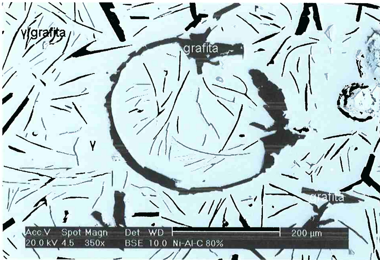
Figura 22: Amostra 05 bruta de solidificação. Imagem de microscópio eletrônico de varredura com elétrons retroespalhados mostrando uma gota fria. Matriz de fase \gamma , com grafita primária e secundária. Aumento: 350X.
