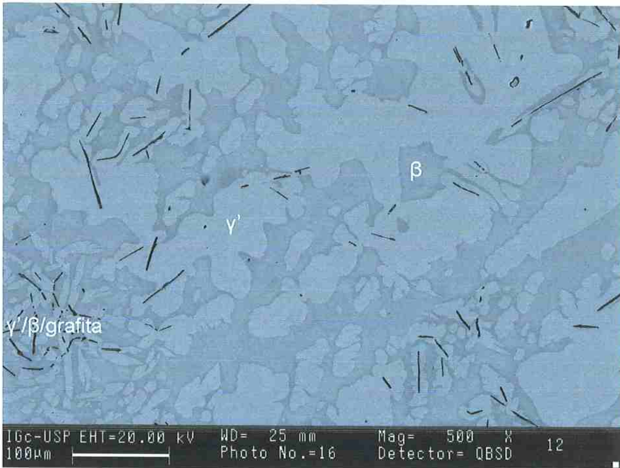
Figura 29: Amostra 12 bruta de solidificação. Imagem de microscopia eletrônica de varredura com elétrons retroespalhados mostrando estrutura dendrítica com presença de fases \gamma' (clara) e \beta (escura). Presença de grafita em regiões trifásicas \gamma'/\beta /grafita. Aumento: 500X.
