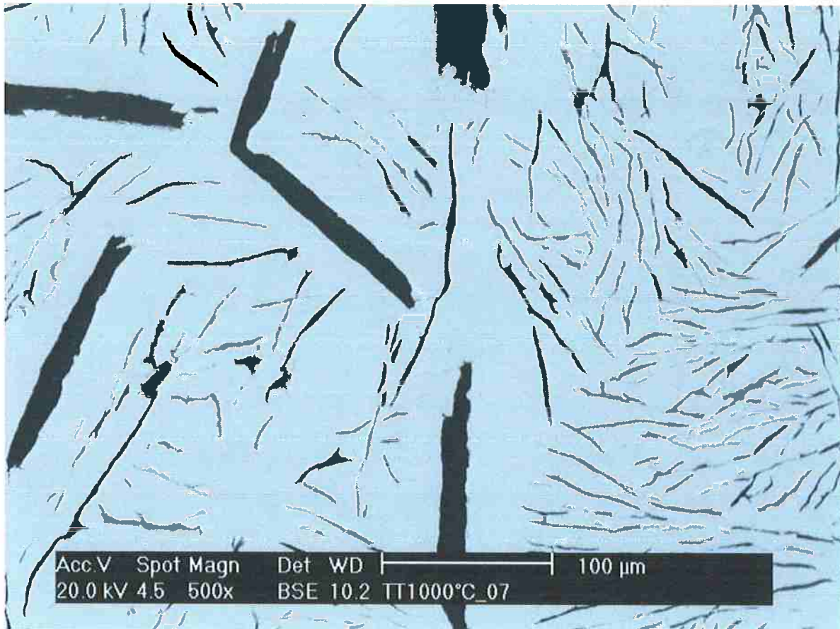
Figura 40: Amostra 07, solubilizada a 1000°C. Imagem de microscópio eletrônico de varredura com elétrons retroespalhados. Presença de fase \gamma (Ni-0,02Al). Aumento: 500x.
