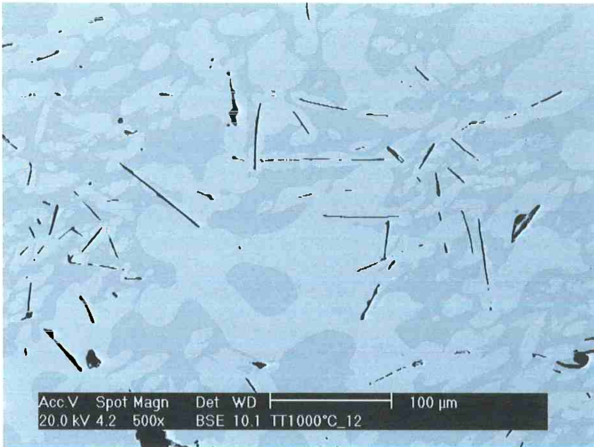
Figura 45: Amostra 12, solubilizada a 1000°C. Imagem de microscópio eletrônico de varredura com elétrons retroespalhados. Presença de fase \gamma' (Ni-0,15Al – clara) e \beta (Ni-0,22Al – escura). Aumento: 500x.
