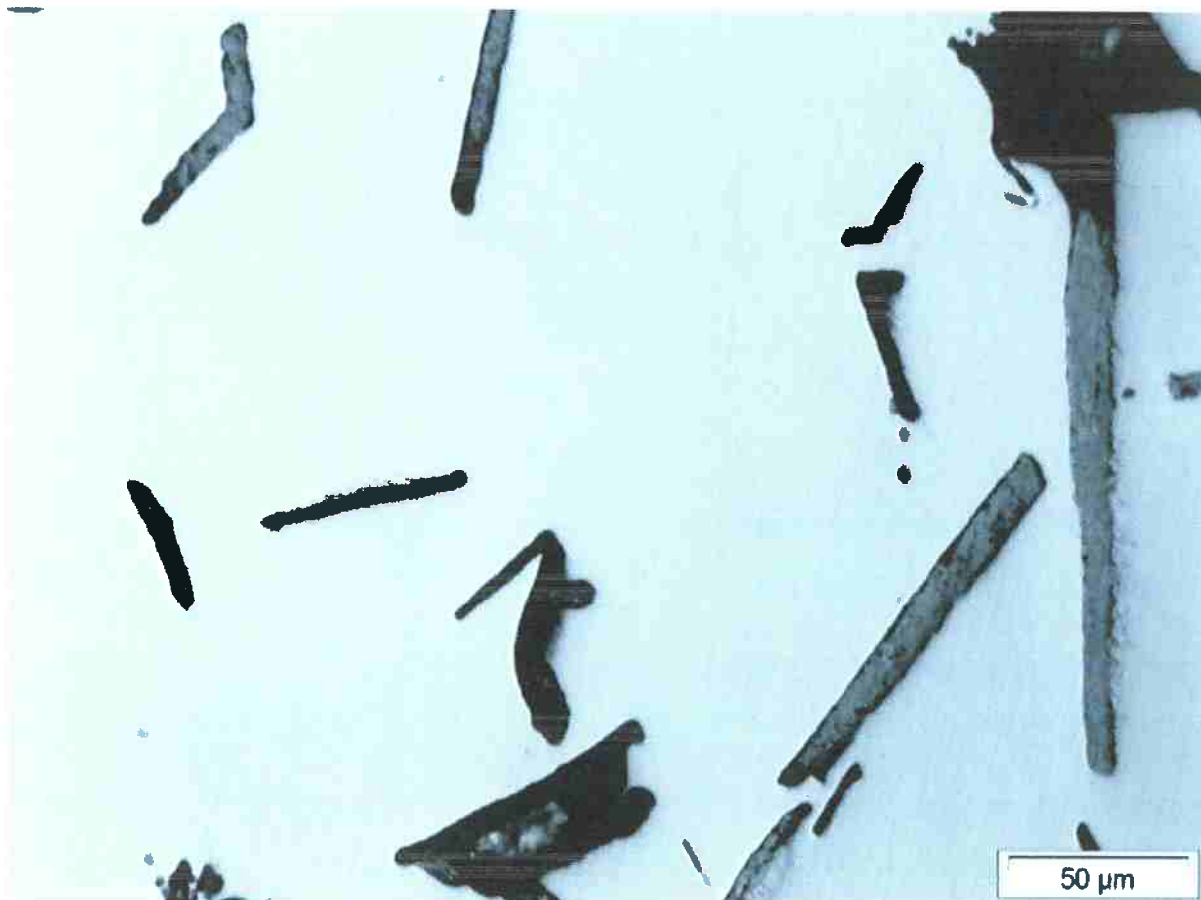
Figura 18: Amostra 01, bruta de solidificação. Imagem de microscopia óptica indicando grafita lamelar primária e matriz monofásica ( \beta ). Aumento: 200X.
