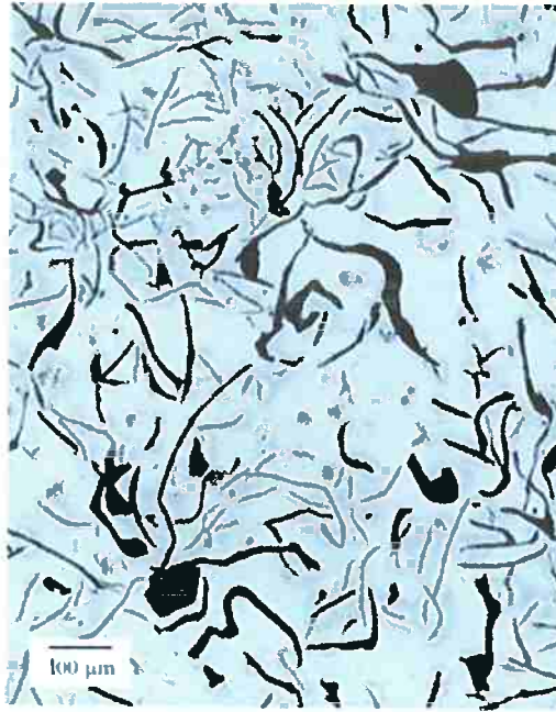
Figura 10: Ferro fundido cinzento com matriz ferrítica.
