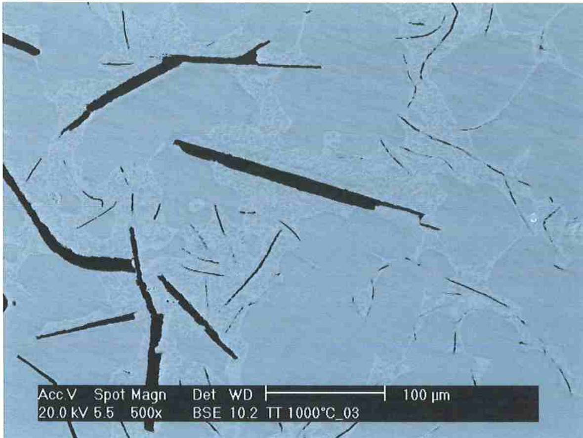
Figura 36: Amostra 03, solubilizada a 1000°C. Imagem de microscópio eletrônico de varredura com elétrons retroespalhados. Presença de fases \gamma (Ni-0,07Al – clara) e \gamma' (Ni-0,12Al – escura). Aumento: 500x.
