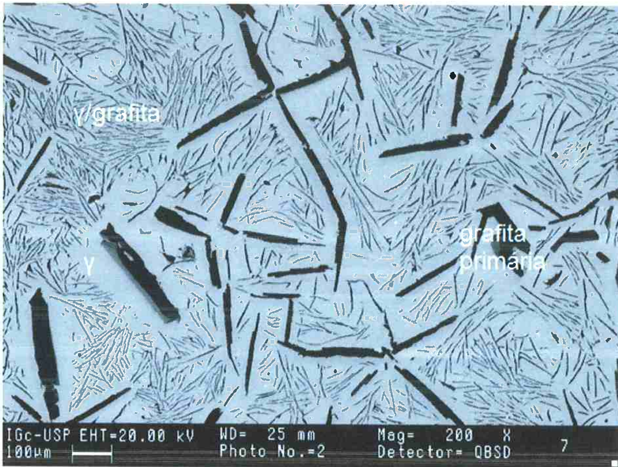
Figura 24: Amostra 07 bruta de solidificação. Matriz monofásica de \gamma , com em lamelas finas e grossas de grafita secundária e primária, respectivamente. Imagem de microscópio eletrônico de varredura com elétrons retroespalhados. Aumento: 200X.
