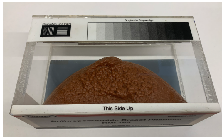
Figura 14 – Simulador antropomórfico de mama Nuclear Associates modelo 18-226 (Rachel).
