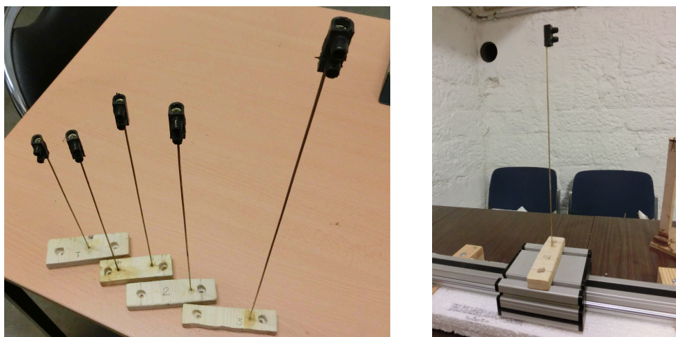
Figura 8: Hastes formando o sistemas a vários modos vibrantes.
