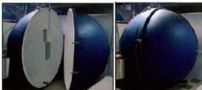
Figura 12 - Esfera integradora utilizada nos ensaios
