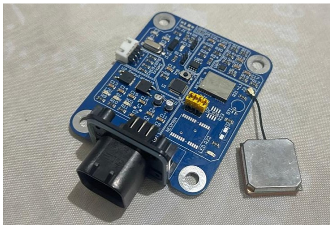
Figura 13 – Placa após solda dos componentes
