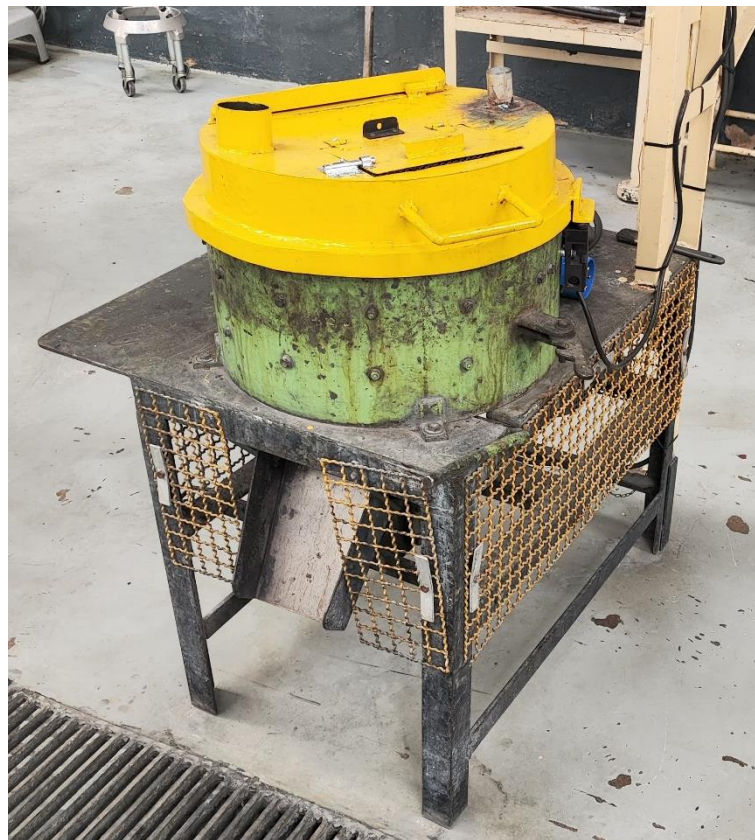
Figura 10 – Misturador de rolos utilizado neste trabalho
