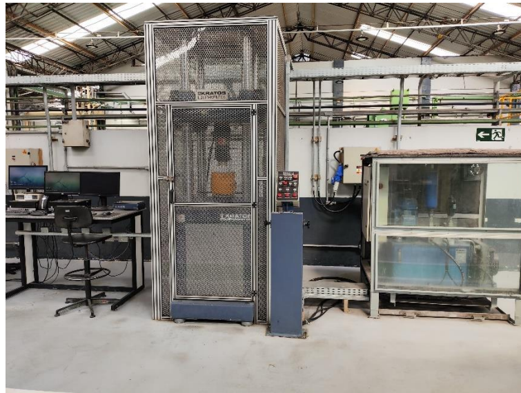
Figura 14 – Máquina universal de ensaios Kratos ECC 100 MP utilizada nos testes deste trabalho
