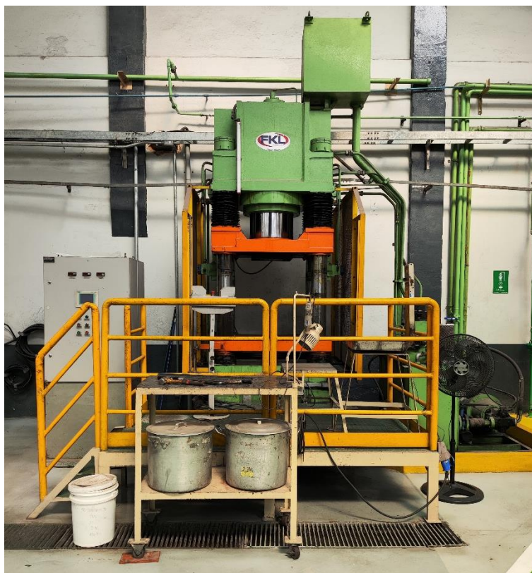
Figura 12 – Prensa hidráulica utilizada para conformação dos tijolos
