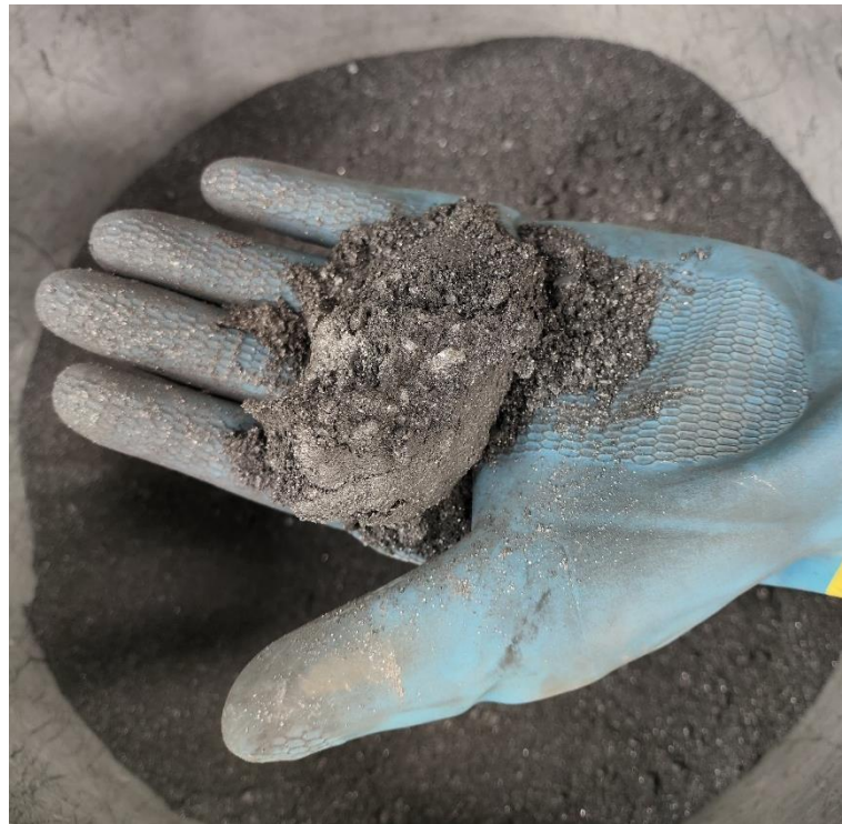
Figura 11 – Exemplo de teste manual de plasticidade da massa após mistura
