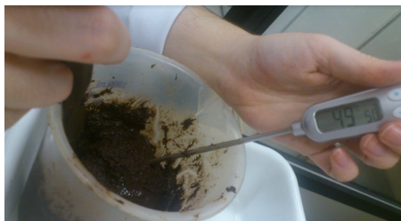
Figura 1. Líquor de cacau peruano ainda se apresentava pastoso e pouco fluido durante o aquecimento, mesmo sob alta temperatura (quase 50°C).
