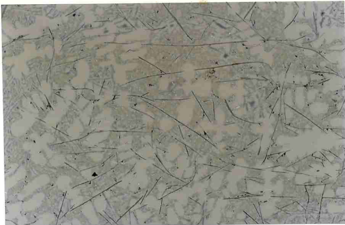
fig.18: Aspecto da fase Fe- \beta com pequeno aumento (100x).
