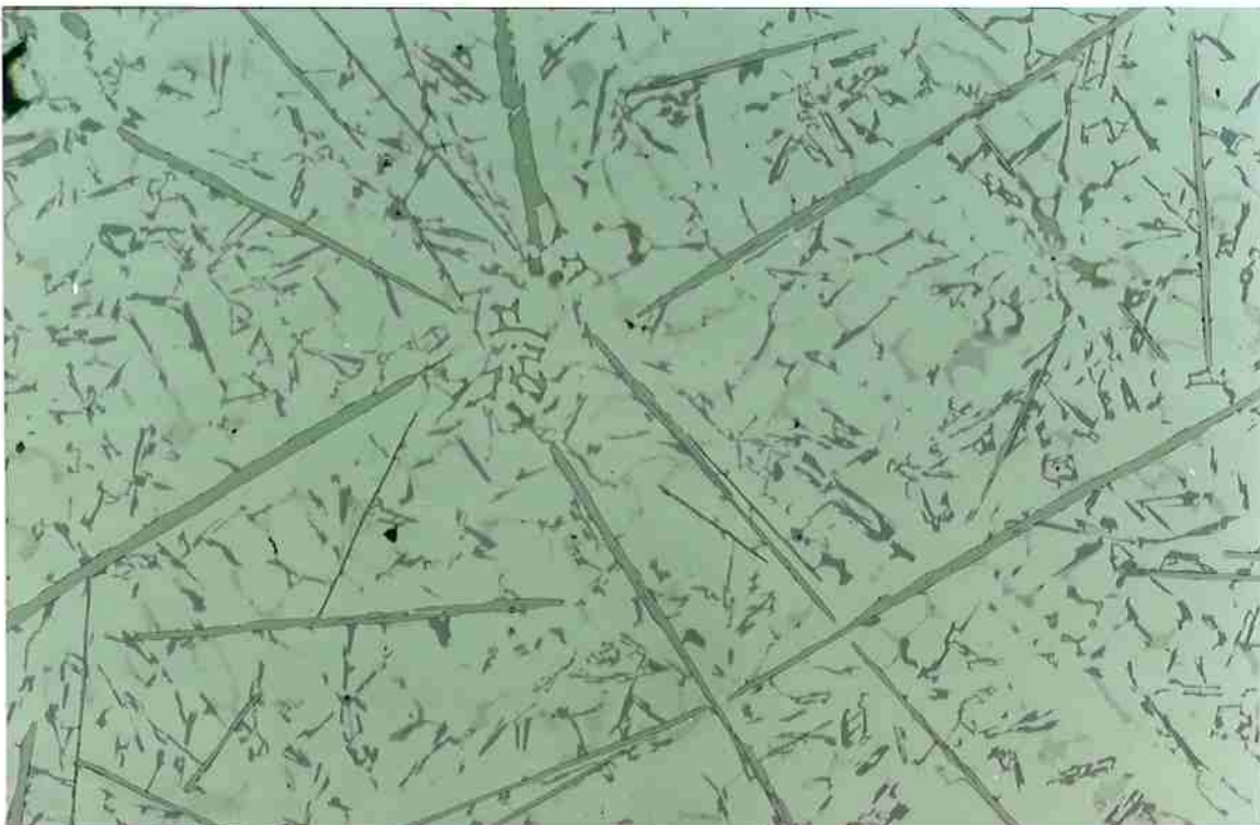
fig. 10: micrografia do corpo-de-prova CP4. A foto exhibe grandes agulhas de fase \beta , Si não modificado, fases ricas em ferro Al_{15}(Fe,Mn)_3Si_2 , CuAl_2 e eutéticos complexos.
