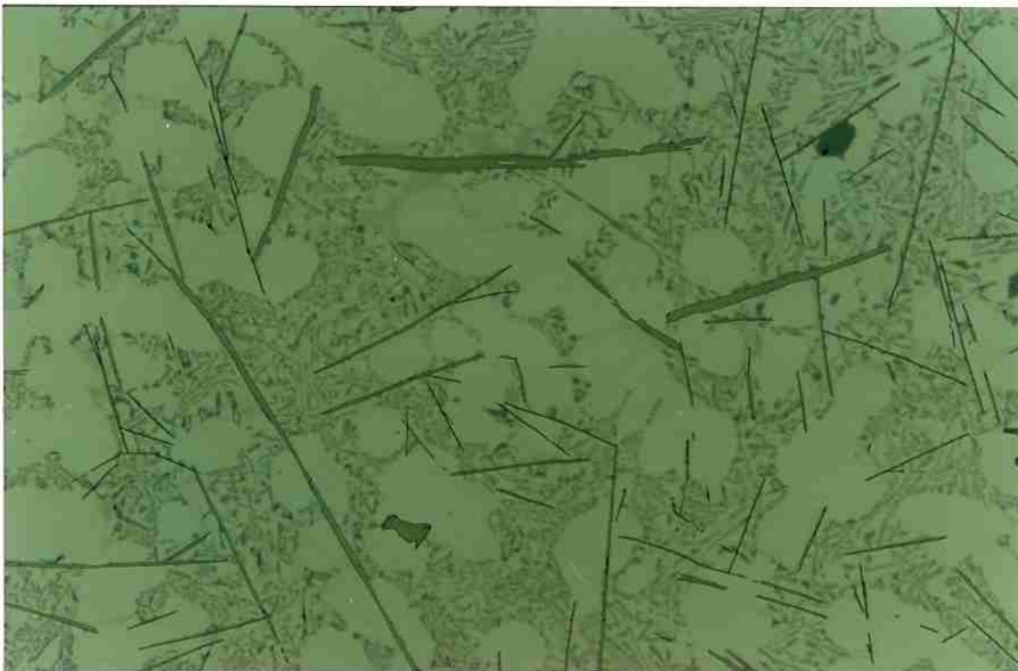
fig. 11: microestrutura do corpo-de-prova CP1 (7) . Nota-se a presença de agulhas de fase \beta e dendritas de Al com estrutura grosseira, que são as primeiras fases a se formar.
