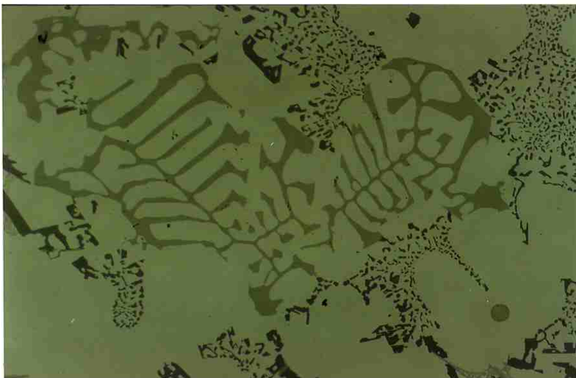
fig. 26: detalhe da morfologia dendrítica (500X).
