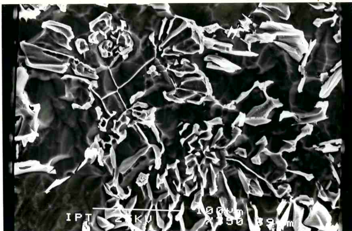
fig.24: micrografia com ataque profundo em M.E.V. mostrando a fase de escrita chinesa.
