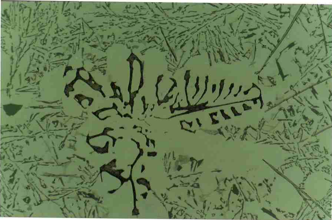
fig. 12: microestrutura do corpo-de-pova CP2 (7) . Nota-se a presença de ferro- \beta , dendritas de Al e fase de ferro- \alpha . Nesta região ocorre a formação da fase \text{Al}_{15}(\text{Fe}, \text{Mn})_3\text{Si}_2 .
