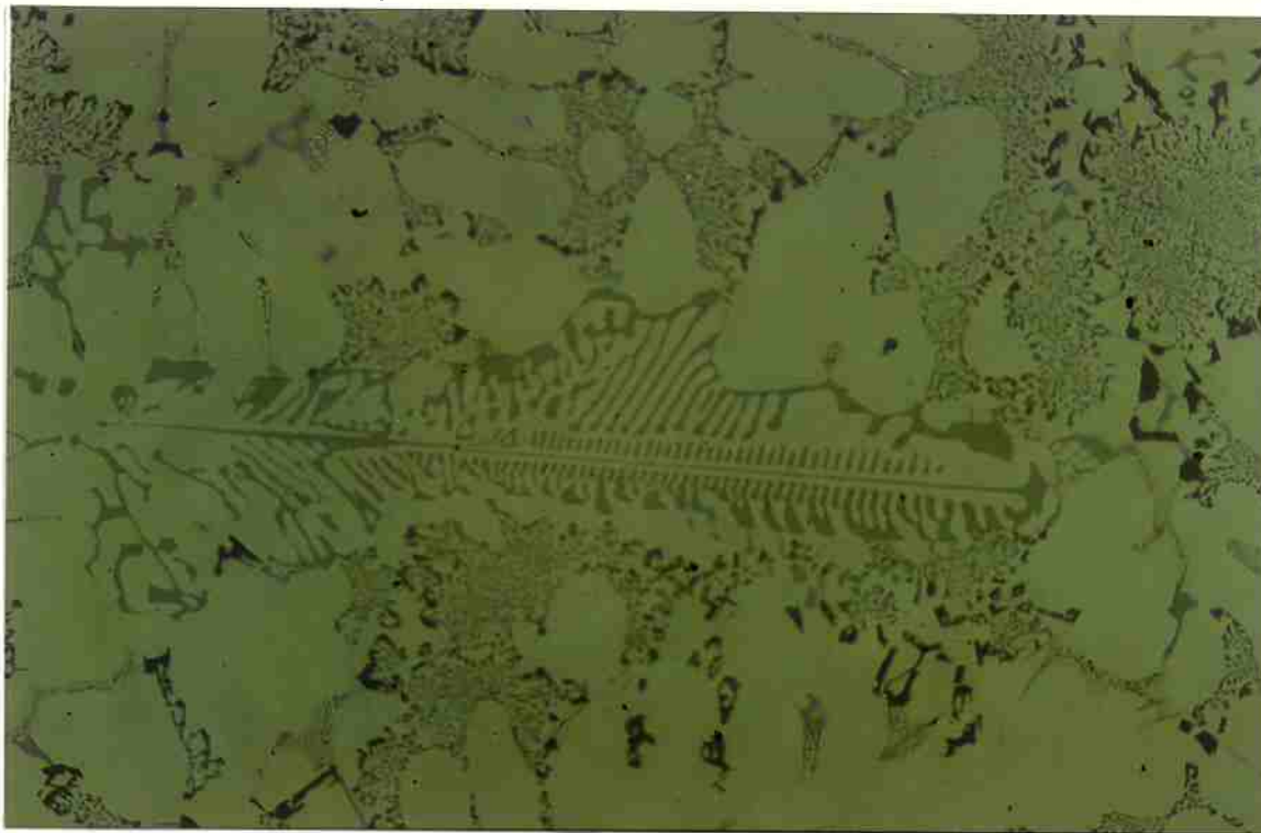
fig. 25: fase de ferro na morfologia dendrítica (aumento 250X).
