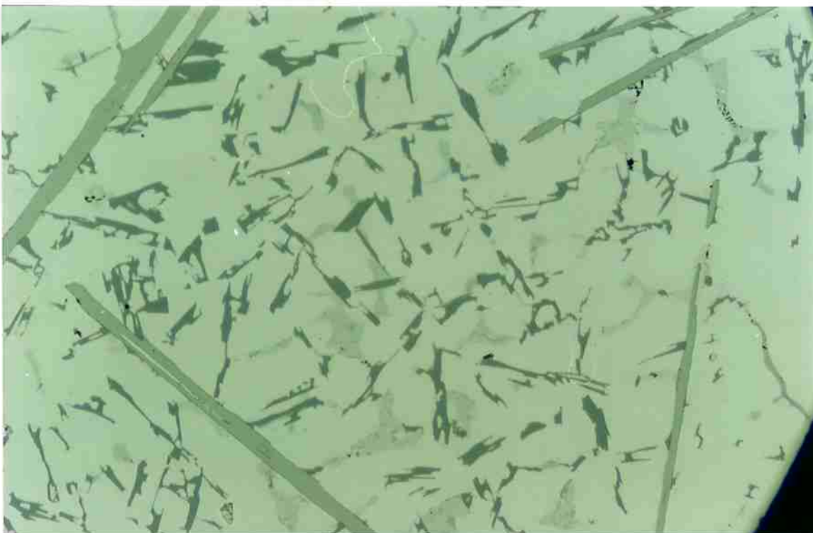
fig. 13: microestrutura do corpo-de-prova CP3 (7) . Nesta região há formação do eutético \text{Al} + \text{Si} e agulhas secundárias de \text{Al}_5\text{FeSi} .
