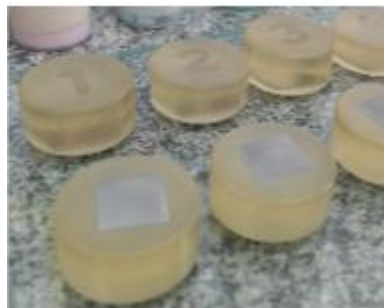
Figura 21 - Amostras após embutimento e identificação.
