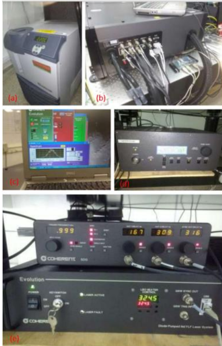
Figura 11 - Componentes principais do sistema de laser de femtossegundo Libra-S. (a) Chiller, (b) Controle do Amplificador, (c) Laptop com softwares instalados, (d) Fonte de Alimentação e controle do Laser Vitesse e (e) SDG e Evolution.
