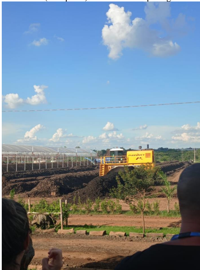
Figura 12: Usina Verde (Campinas) – Pátio de compostagem de lodo de esgoto
