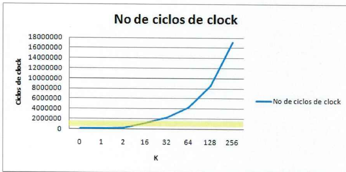
Figura 8.1: Comparação entre o desempenho medido em software e calculado em hardware para operações de encriptação com RSA 256
