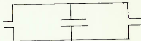
Câmara de Expansão Dupla com Tubos de Conexão In- terna
