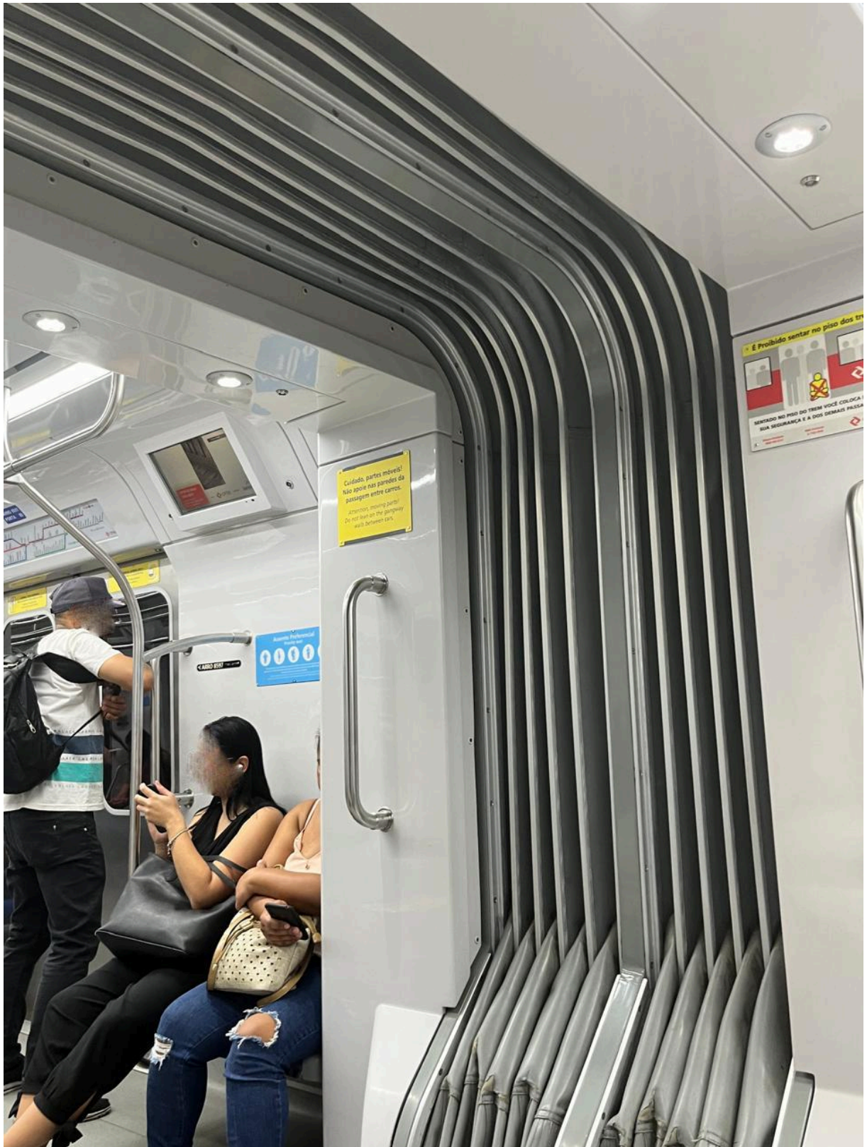
Figura 26 – Estrutura de conexão de vagões de trem
