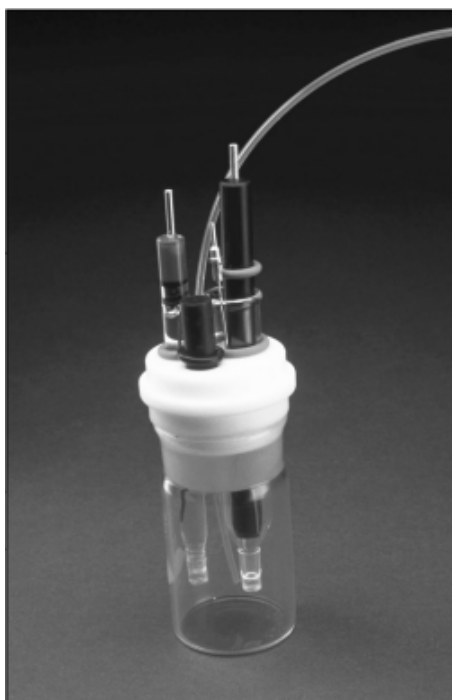
Figura 3: Célula eletroquímica utilizada para as medidas experimentais.
