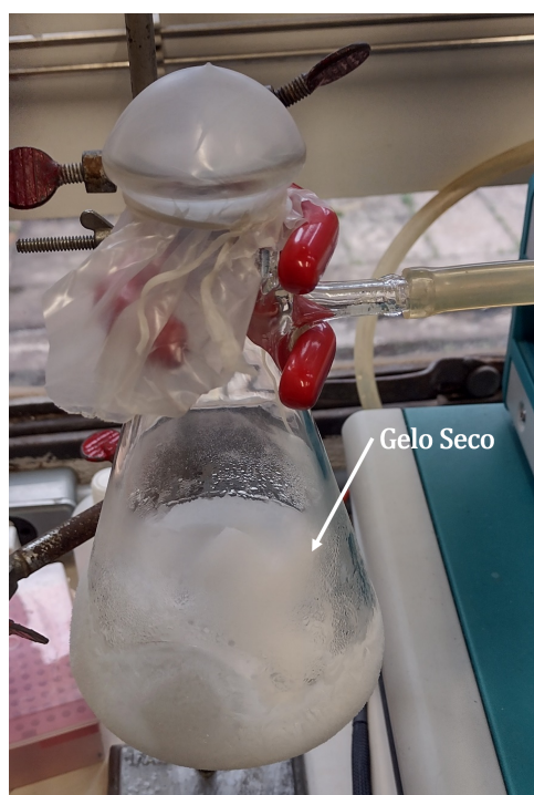
Figura 15: Arranjo para obtenção de solução saturada de \text{CO}_2
