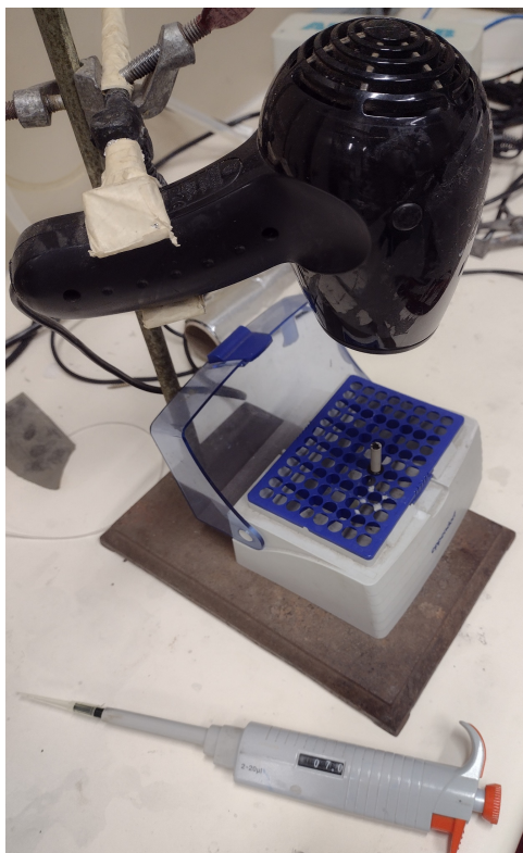
Figura 16: Arranjo para realização da técnica de drop-casting.
