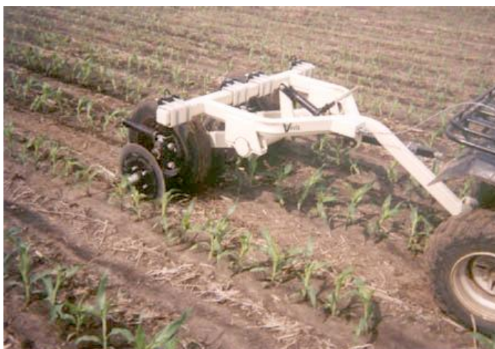
Figura 10 - Medidor de condutividade elétrica do solo – Modelo VERIS200 (VERIS, 2012)
