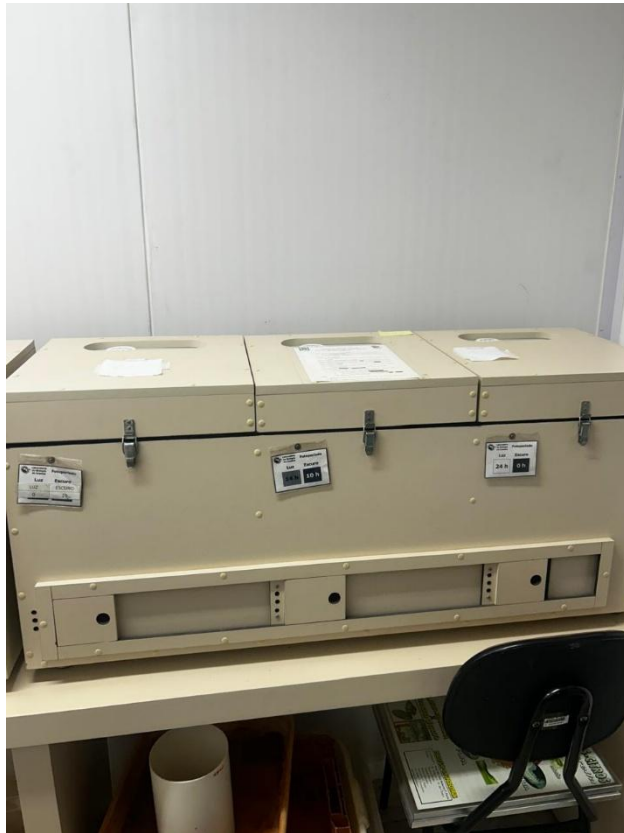
Figura 1: Equipamento desenvolvido por Parra et al (2010) para estudos de fotoperíodo no desenvolvimento de insetos, dividido em 6 compartimentos individualizados.
