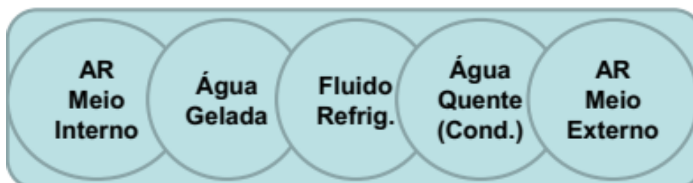
Figura 7: Expansão indireta (chiller condensação a água) – (IOSHIMOTO, E., 2018)
