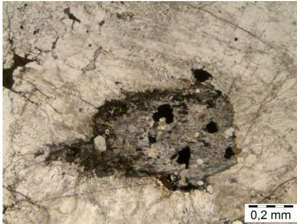
Fotomicrografia 9: Álcali feldspato sienito. Clinopiroxênio incluído nos feldspatos com inclusões de opacos, biotita e apatita. Apresenta aspecto corroído com núcleo incolor e bordas mais esverdeadas. (Polarizadores descruzados).
