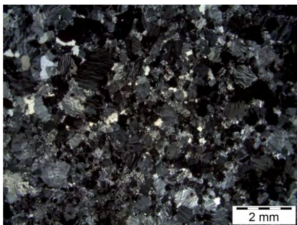
Fotomicrografia 17: Alkali feldspato-quartzo microssienito. Textura inequigranular com concentrações de quartzo (em branco) em torno de 10%. (Polarizadores cruzados)
