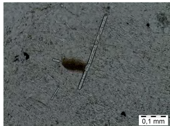
Fotomicrografia 12: Álcali feldspato sienito. Apatita com hábito acicular inclusa no feldspato. (Polarizadores descruzados).
