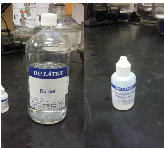
Figura 9 a) Resina epóxi usada para o embutimento a frio e b) catalisador para o processo de cura da resina
