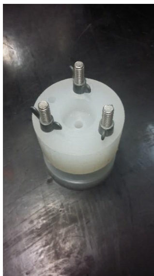
Figura 10 Microcélula utilizada nos ensaios eletroquímicos
