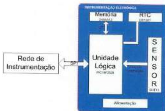
Figura 74 - Divisão funcional do módulo T10 Interface Instrumentação.
