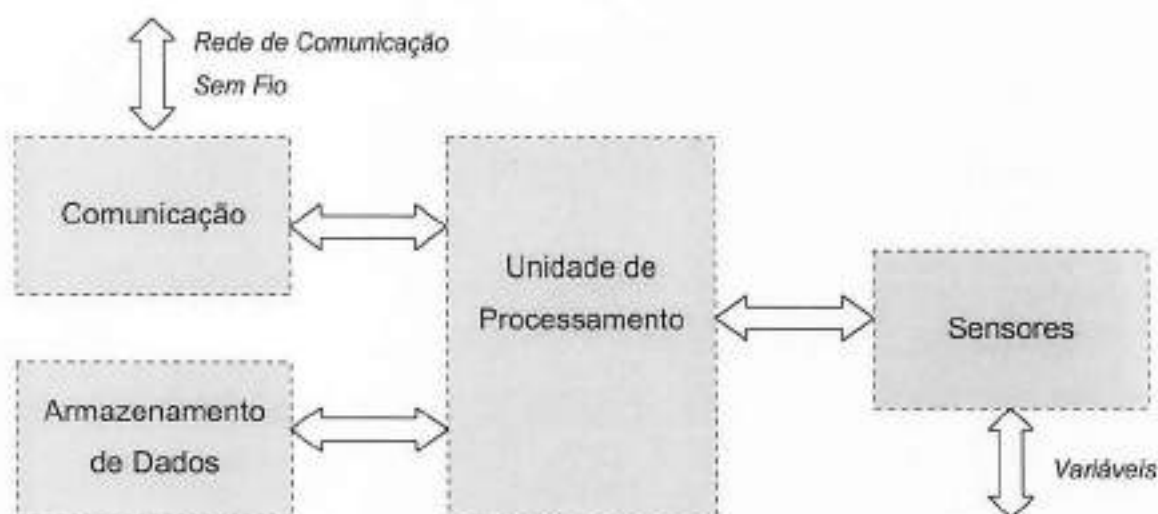
Figura 17 – Arquitetura básica da Instrumentação Eletrônica.
