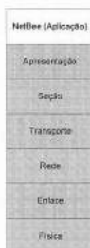
Figura 48 – Arquitetura em camadas do protocolo NetBee.
