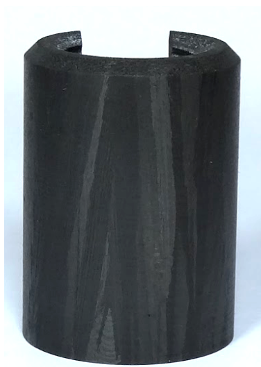
Fig. 22 - Amostra 6 após ataque em solução 300 ml de ácido clorídrico (HCl) + 100 ml de peróxido de hidrogênio (H 2 O 2 ) por 15 minutos. É possível observar que o material é policristalino e a direção dos grãos é vertical.
