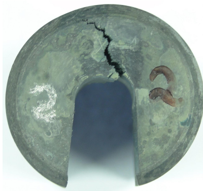
Fig. 16 - Grau avançado da trinca na amostra 2. Visão da região de encaixe do corpo de prova.
