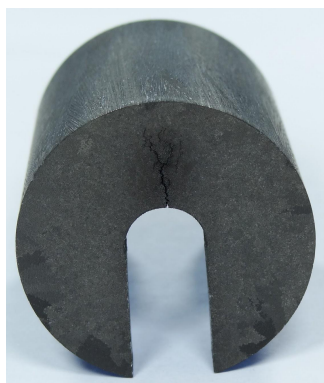
Fig. 23 - Amostra 6 após ataque em solução 300 ml de ácido clorídrico (HCl) + 100 ml de peróxido de hidrogênio (H 2 O 2 ) por 15 minutos. É possível observar a presença de trinca na região central.
